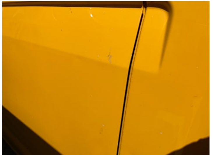
Türe hinten links (Lackschaden)
