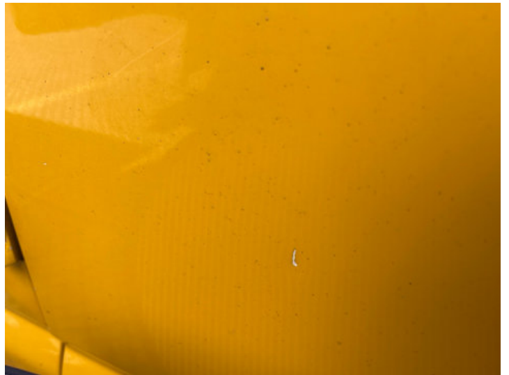
Beifahrertür (Delle, Lackschaden)
