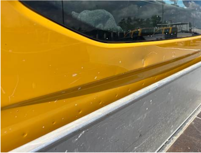
Seitenteil hinten links (Lackschaden, Kratzer, Delle)
