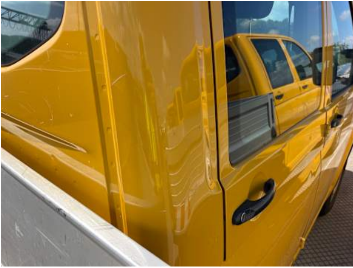
Seitenteil hinten rechts (Lackschaden, Kratzer)
