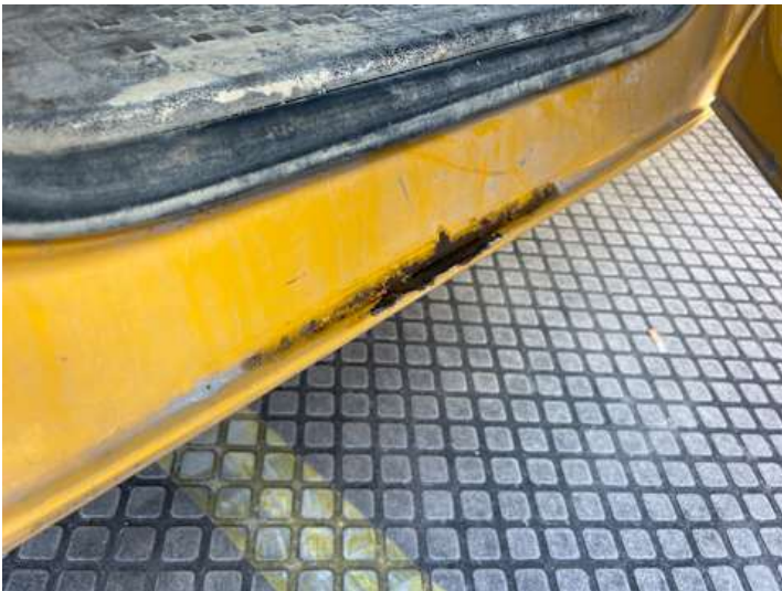
Schweller rechts (Lackschaden, Rost)
