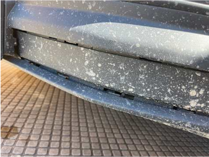
Stoßstange vorne (Spaltmaße ungenau)
