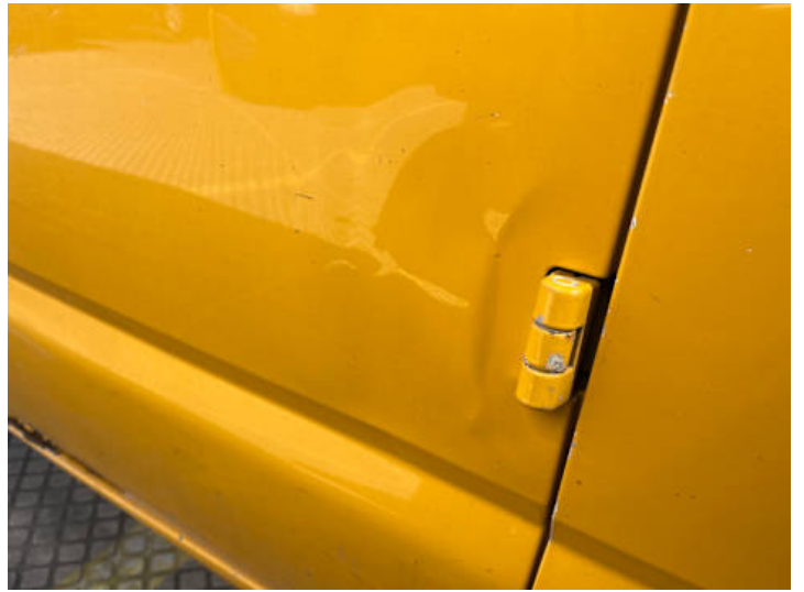
Türe hinten rechts (Verformung)
