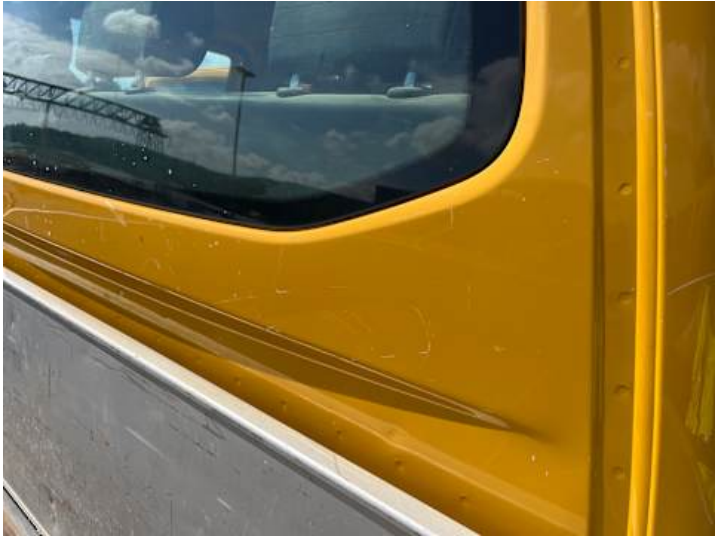
Seitenteil hinten rechts (Lackschaden, Kratzer)
