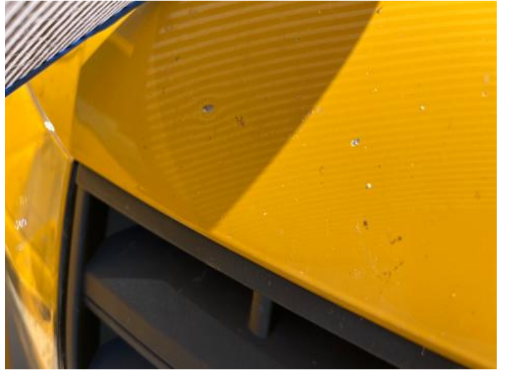
Motorhaube (Lackschaden, Delle)
