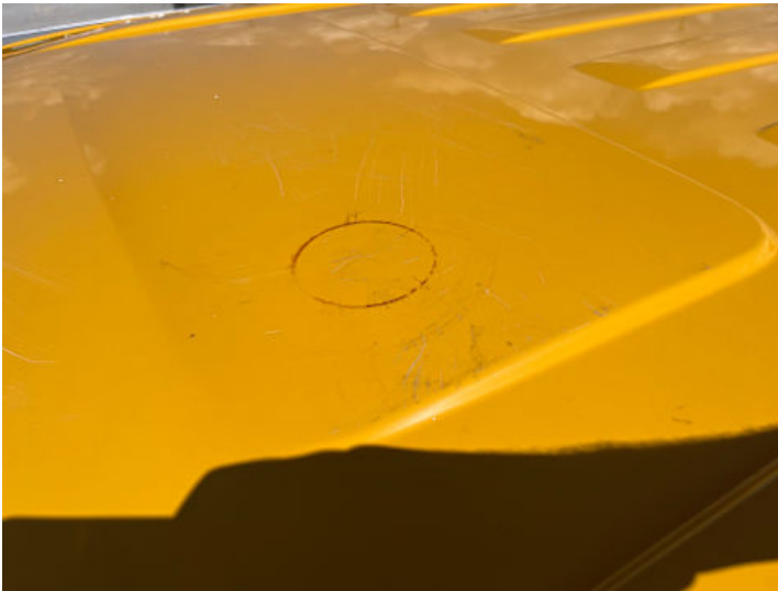
Dach (Lackschaden, Rost)
