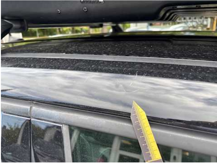
Dach (Kratzer, Lackschaden)
