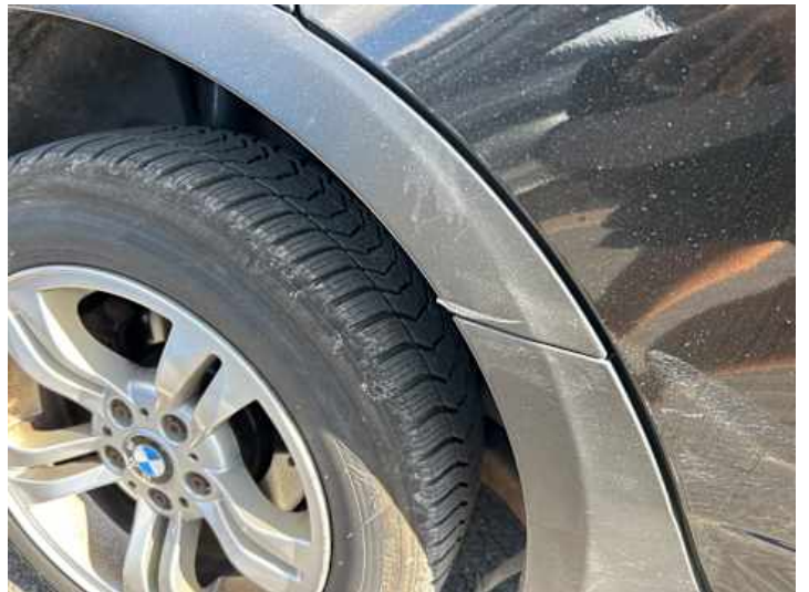
Seitenteil hinten rechts (Kratzer)
