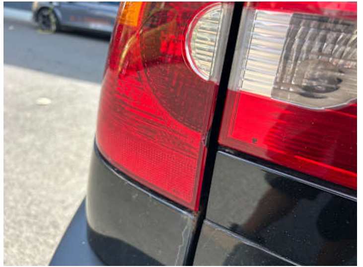
Rücklicht (links) (Riss/Bruch)
