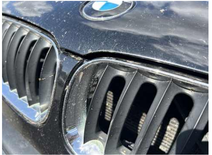
Motorhaube (Rost, Steinschlag)
