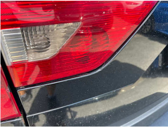
Heckklappe (Spaltmaße ungenau)
