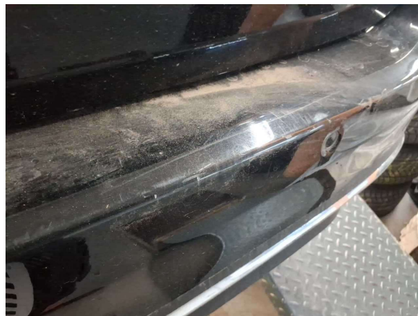
Beschädigung 12: Stossfänger hinten: Stossfänger hinten - verformt - erneuern
