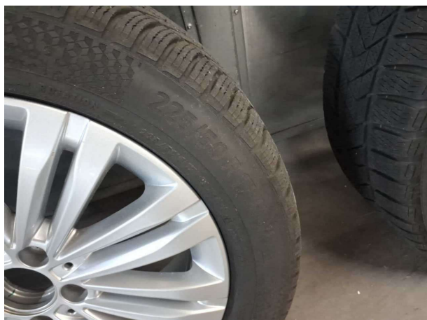
Beschädigung 5: 2.Radsatz: 1 Reifen (Unterschiedliche Reifen) - erneuern
