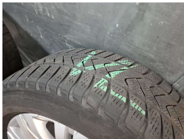
Beschädigung 6: 2.Radsatz: 1 Reifen - verschlissen - erneuern
