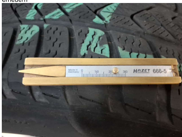
Beschädigung 6: 2.Radsatz: 1 Reifen - verschlissen - erneuern
