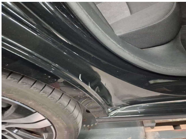
Beschädigung 1: Seitenwand rechts: Einstieg (+ Delle) - verkratzt / verschürft - auslegen / polieren
