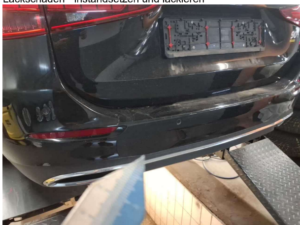
Beschädigung 12: Stossfänger hinten: Stossfänger hinten - verformt - erneuern
