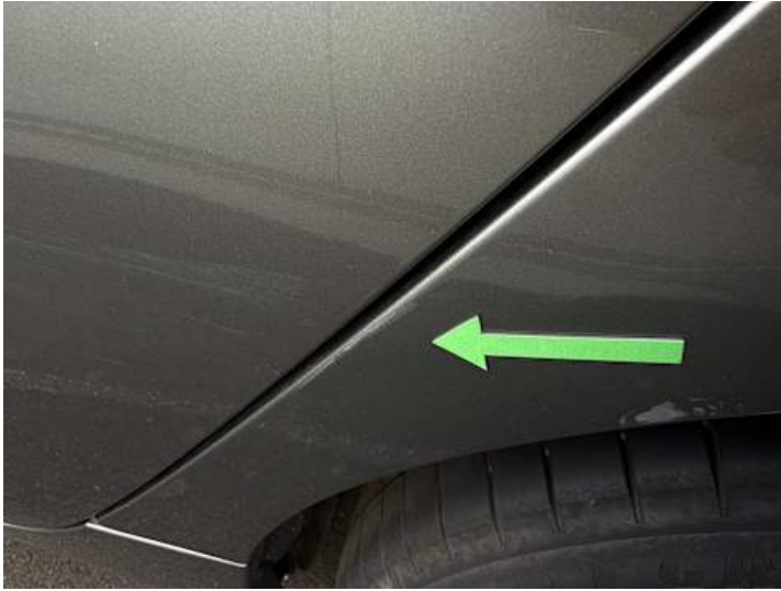
Seitenteil hinten links (Lackschaden, Kratzer)
