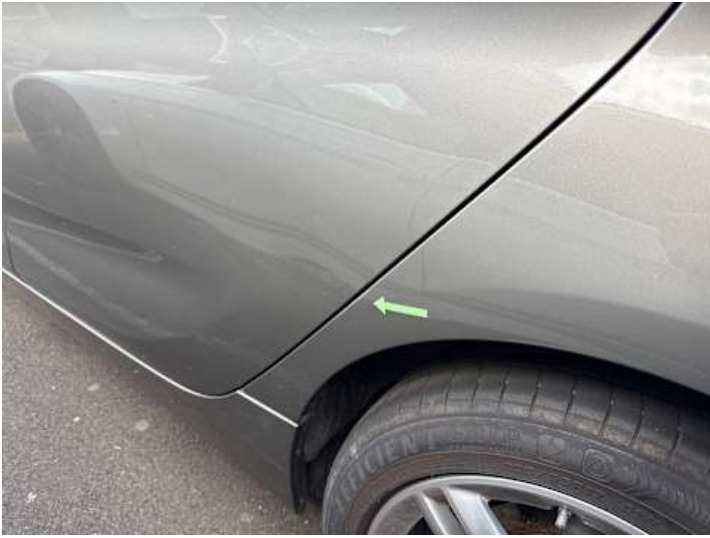
Seitenteil hinten links (Lackschaden, Kratzer)
