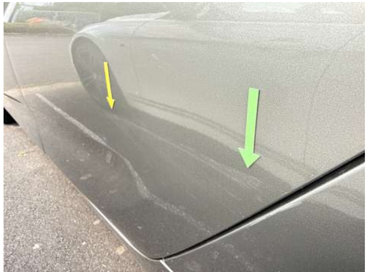
Türe hinten links (Lackschaden, Kratzer)
