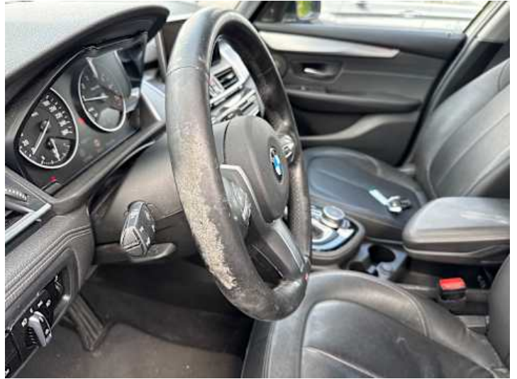
Innenraum (Verschmutzung, Verschleiß)
