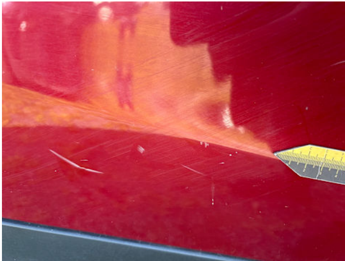
Türe hinten rechts (Kratzer, Unsachgemäß instand gesetzt)
