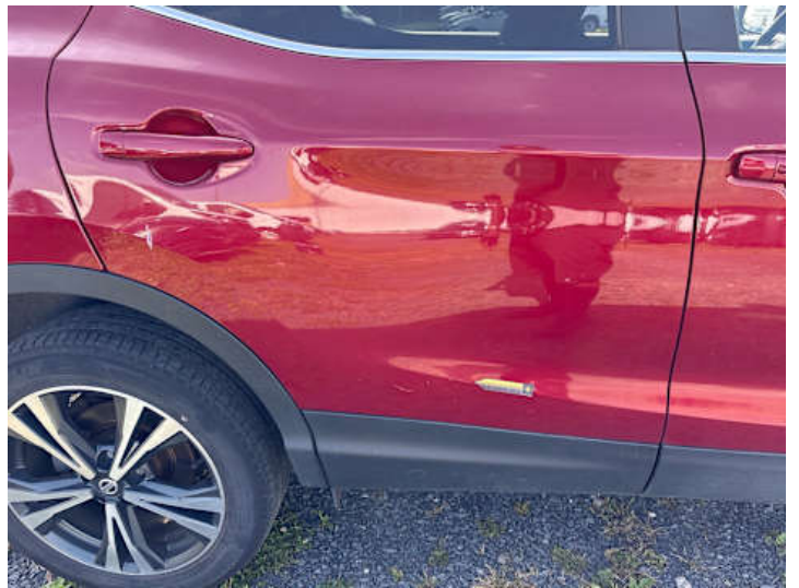
Türe hinten rechts (Kratzer, Unsachgemäß instand gesetzt)
