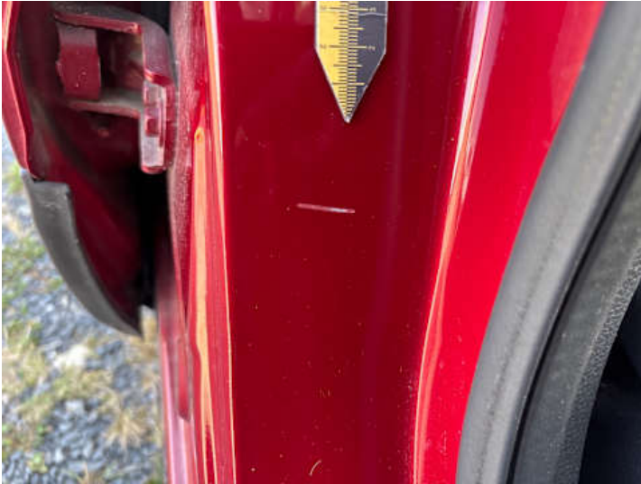
Schweller rechts (Kratzer)
