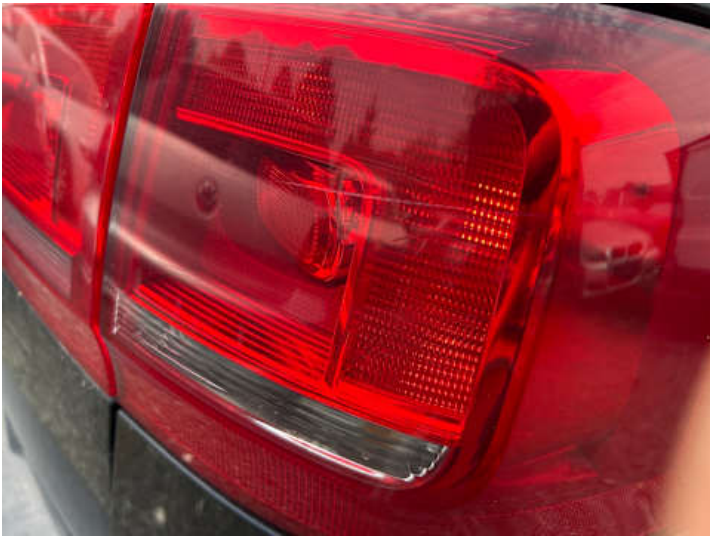
Rücklicht (rechts) (Kratzer)
