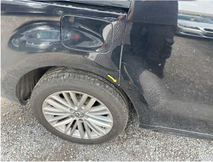
Seitenteil hinten rechts (Lackschaden, Rost)
