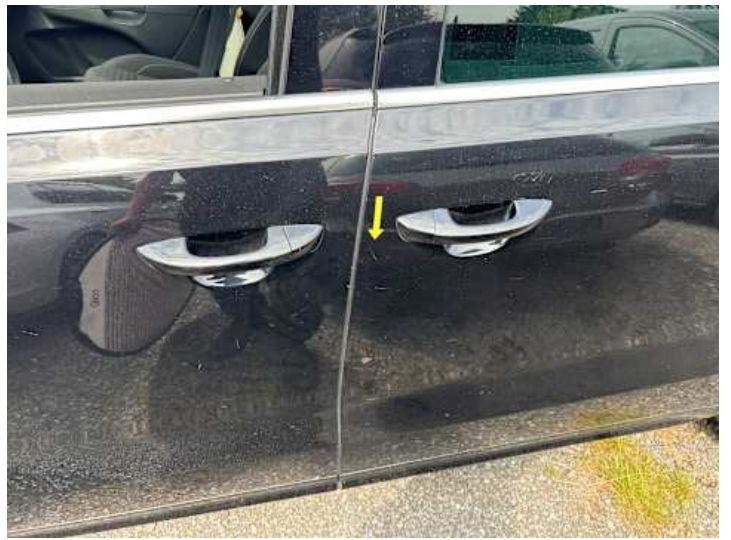
Türe hinten links (Kratzer, Lackschaden)
