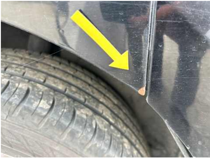
Seitenteil hinten rechts (Lackschaden, Rost)
