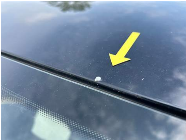
Dach (Lackschaden, Steinschlag)
