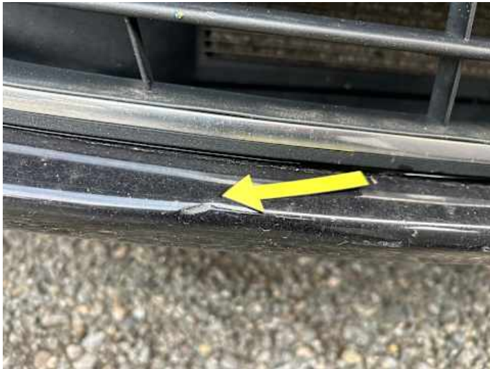
Stoßstange vorne (Lackschaden, Verformung)
