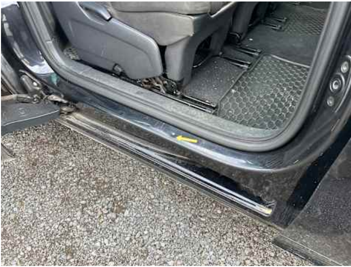
Schweller rechts (Delle)
