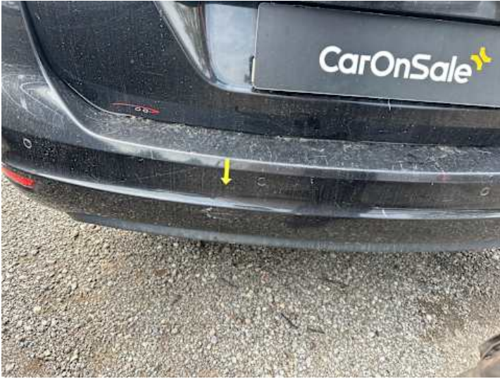
Stoßstange hinten (Lackschaden)
