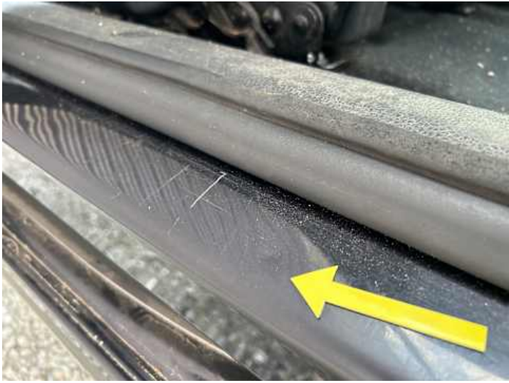
Schweller rechts (Delle)
