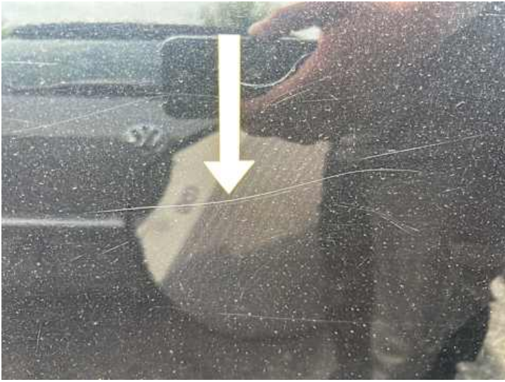
Türe hinten links (Kratzer, Lackschaden)
