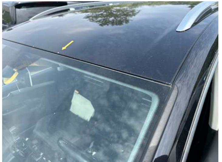
Dach (Lackschaden, Steinschlag)
