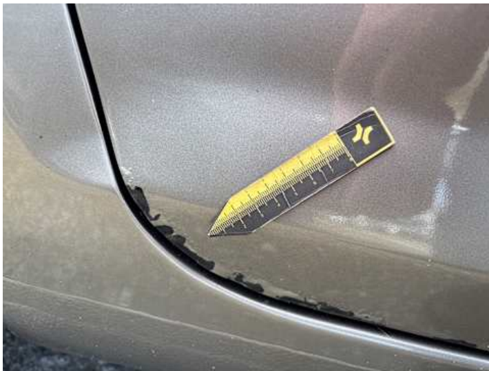
Türe hinten rechts (Rost)
