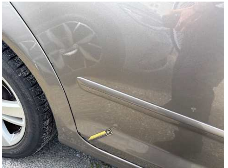
Türe hinten rechts (Rost)
