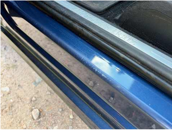
Schweller links (Lackschaden)
