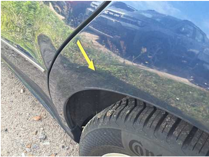
Seitenteil hinten links (Lackschaden)
