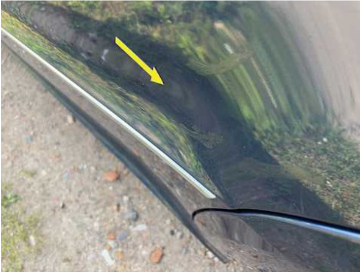
Türe hinten links (Lackschaden)
