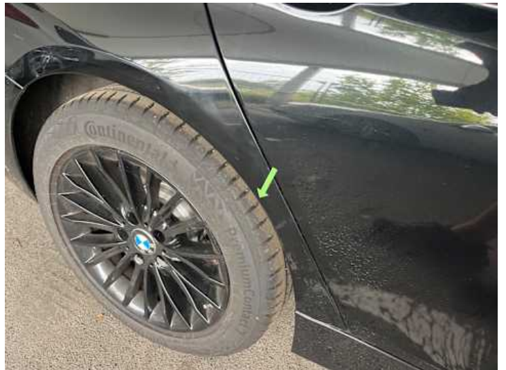
Seitenteil hinten rechts (Rost)
