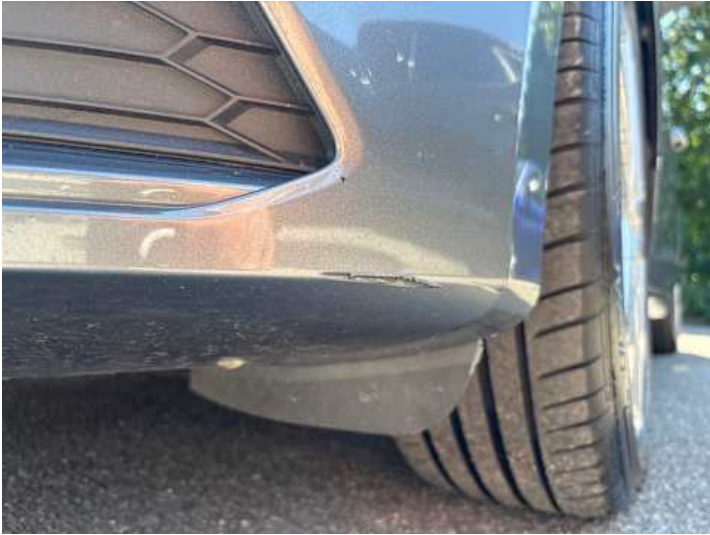
Stoßstange vorne (Kratzer, Lackschaden)
