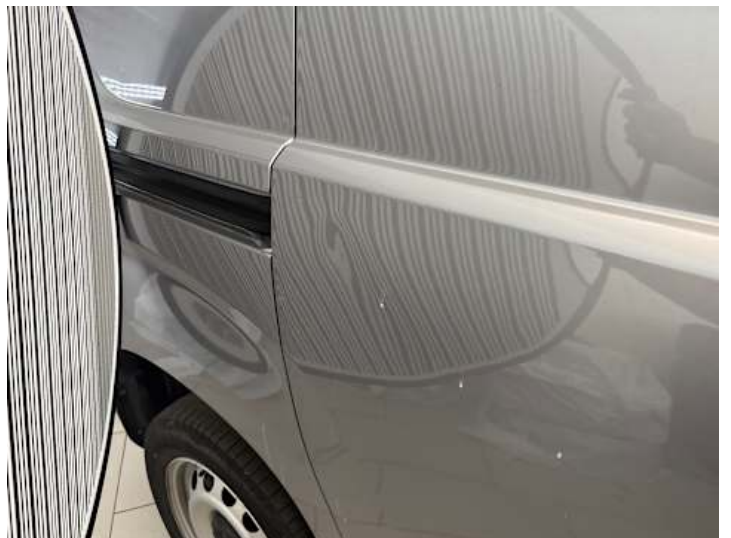
Türe hinten rechts (Verformung)
