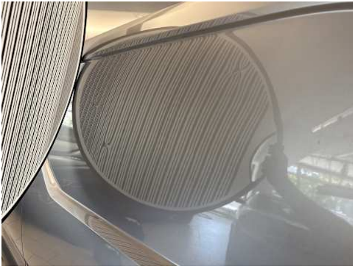
Seitenteil hinten links (Verformung)
