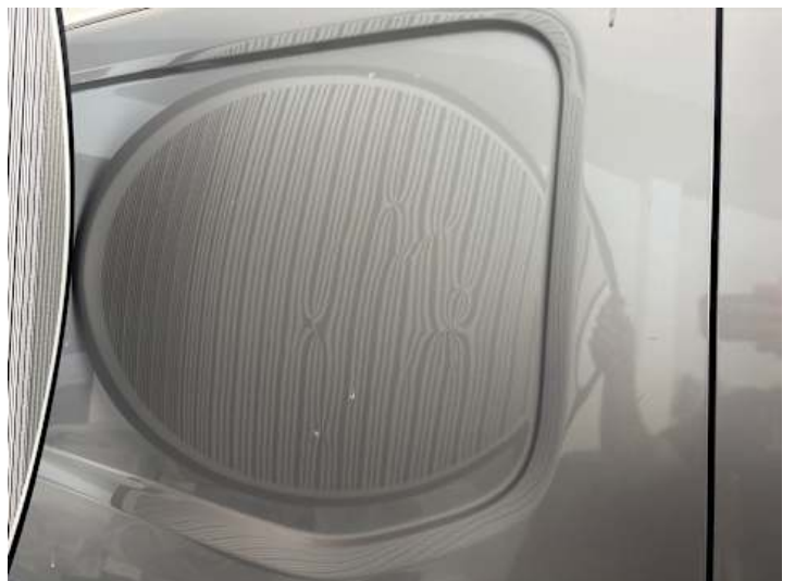
Türe hinten rechts (Verformung)
