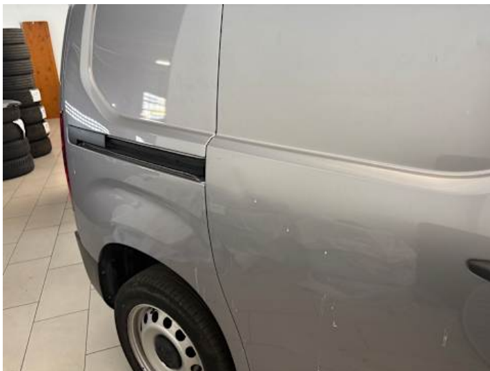
Türe hinten rechts (Verformung)
