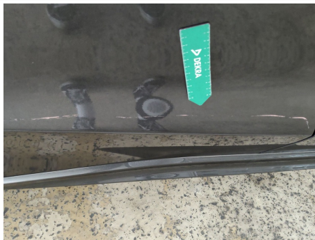
Tür / Hinten Rechts / Kratzer
