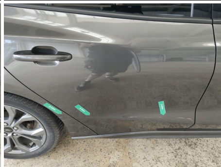
Tür / Hinten Rechts / Kratzer
