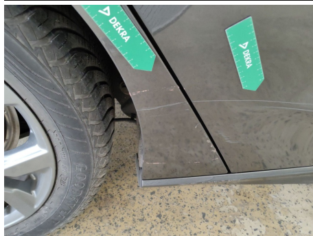
Kotflügel / Hinten Rechts / Kratzer
