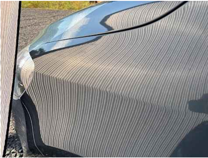
Kotflügel vorne links (Delle, Kratzer, Rost)
