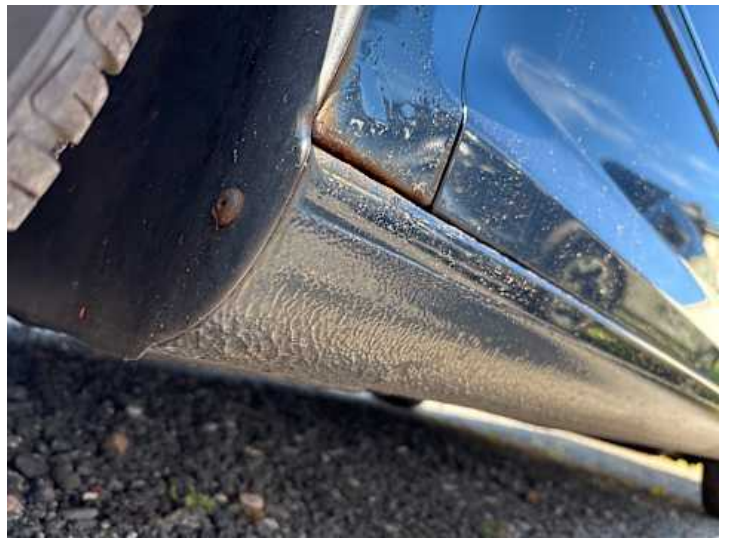
Schweller links (Rost)
