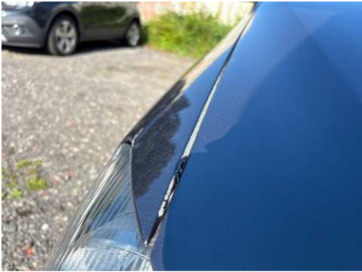
Kotflügel vorne rechts (Lackschaden)
