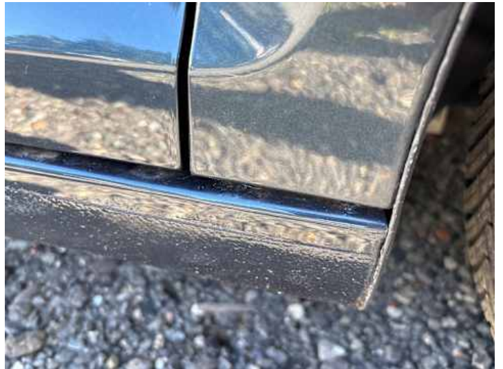
Schweller rechts (Rost)
