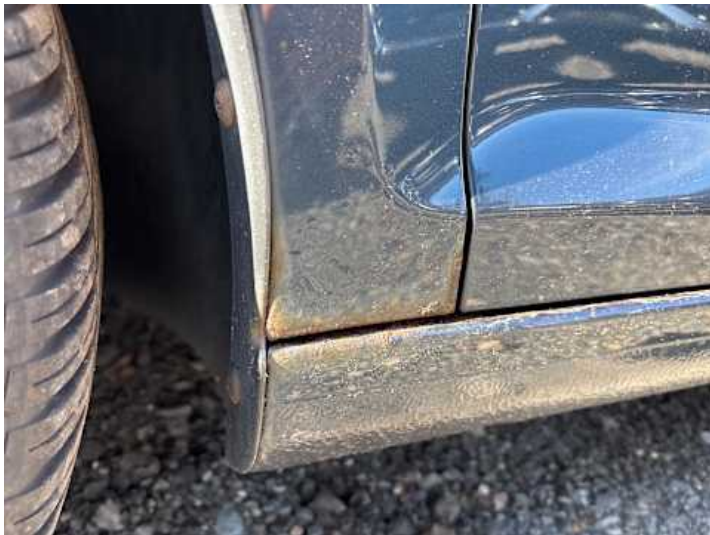
Kotflügel vorne links (Delle, Kratzer, Rost)
