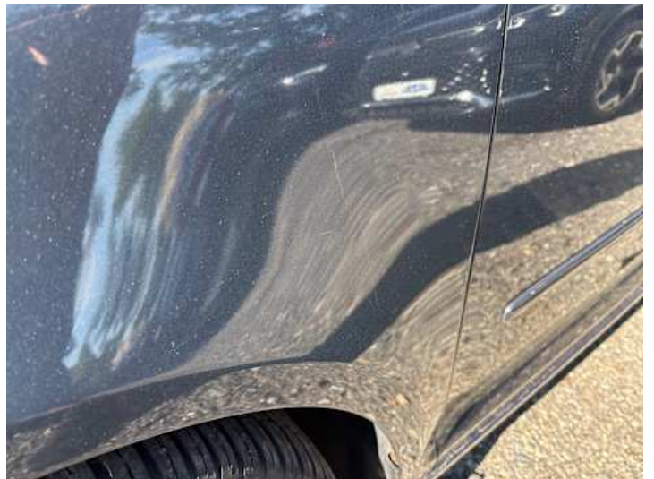
Kotflügel vorne links (Delle, Kratzer, Rost)
