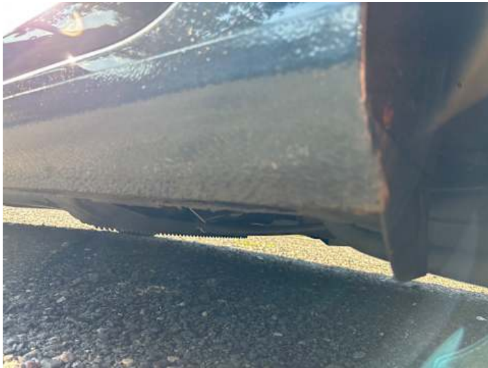
Schweller links (Rost)
