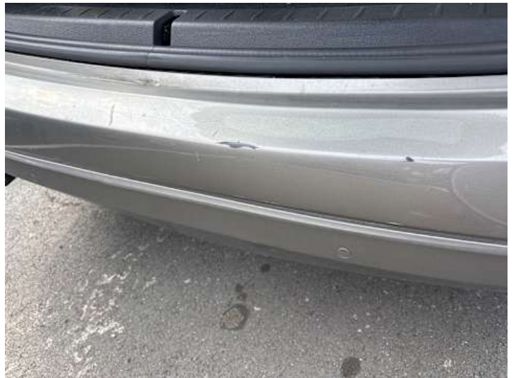
Stoßstange hinten (Kratzer, Verformung, Lackschaden)
