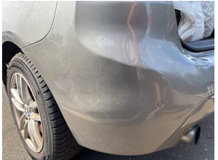
Stoßstange hinten (Kratzer, Verformung, Lackschaden)
