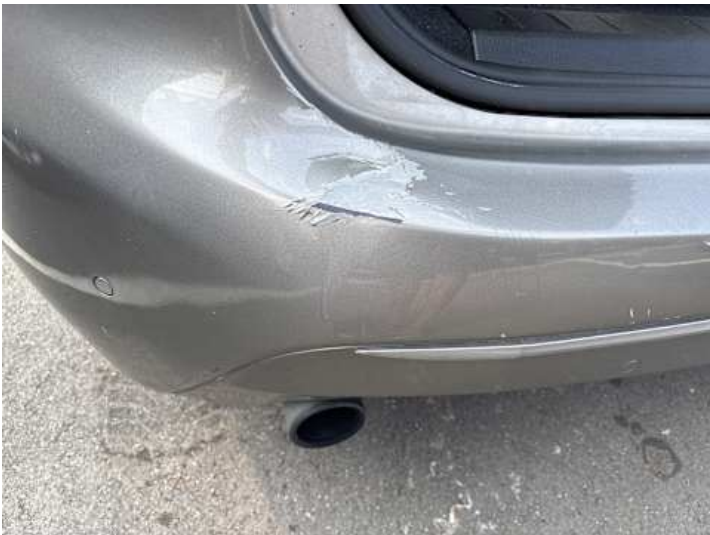
Stoßstange hinten (Kratzer, Verformung, Lackschaden)
