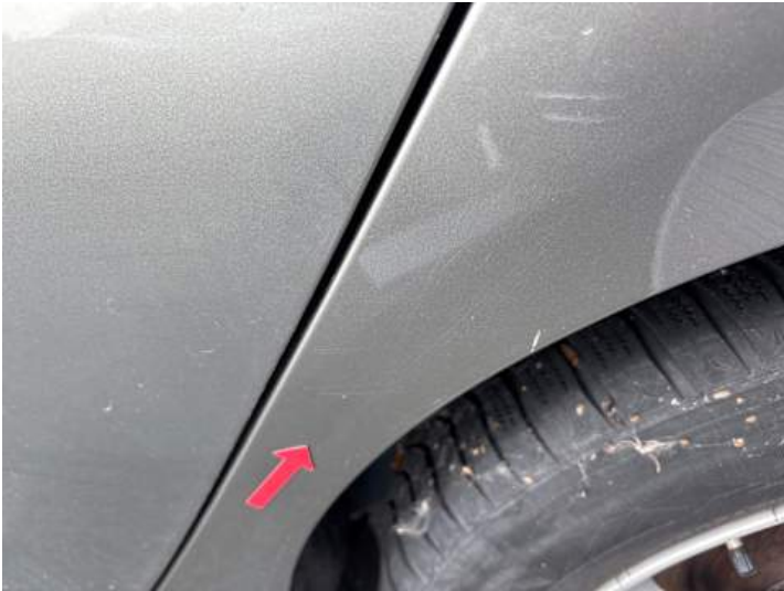
Seitenteil hinten links (Kratzer)
