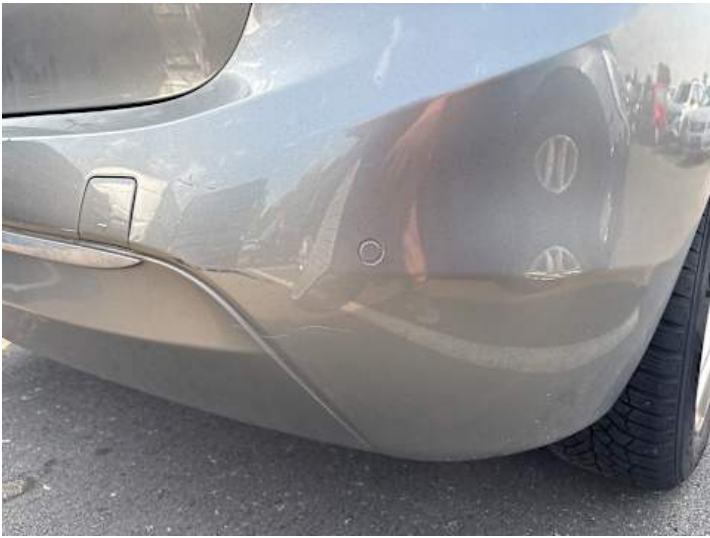
Stoßstange hinten (Kratzer, Verformung, Lackschaden)
