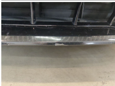
Stoßfänger / Vorne / Gebrochen
