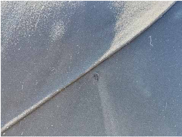
Cabrioverdeck (Riss/Bruch, Verschleiß)
