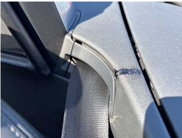
Innenraum (Riss/Bruch, Anderer Schaden): Geklebt
