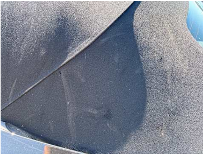
Cabrioverdeck (Riss/Bruch, Verschleiß)
