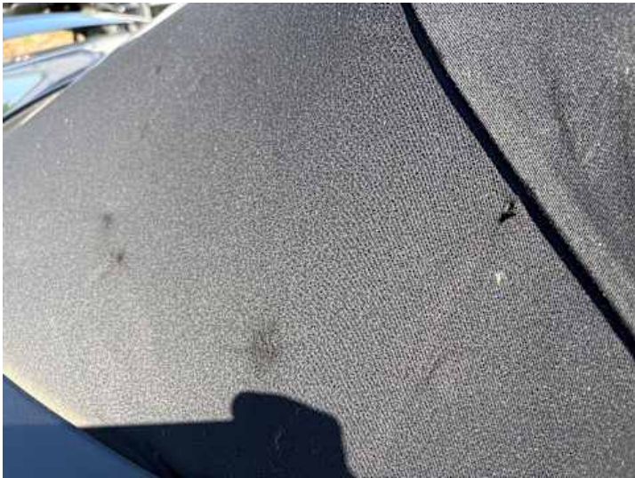
Cabrioverdeck (Riss/Bruch, Verschleiß)
