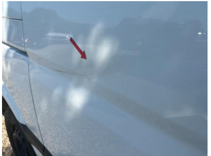
Türe hinten rechts (Lackschaden, Verformung)
