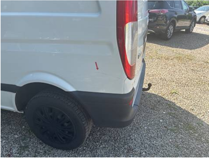
Seitenteil hinten links (Lackschaden, Kratzer)
