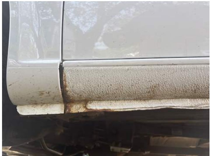
Schweller links (Rost)
