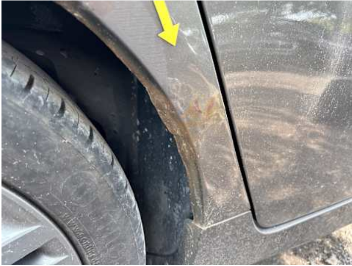
Seitenteil hinten rechts (Rost)
