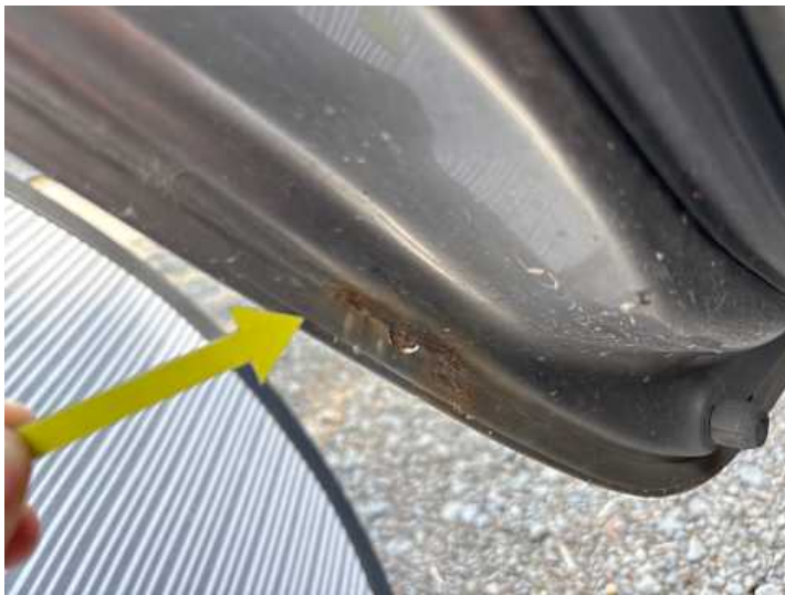
Türe hinten links (Rost)
