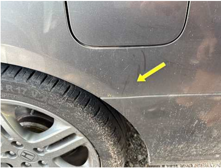
Seitenteil hinten links (Rost)
