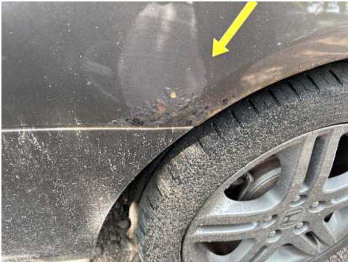
Seitenteil hinten rechts (Rost)
