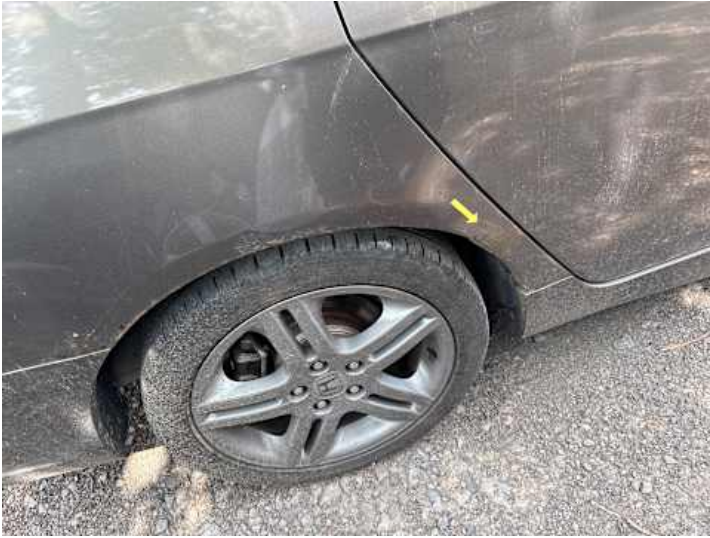
Seitenteil hinten rechts (Rost)
