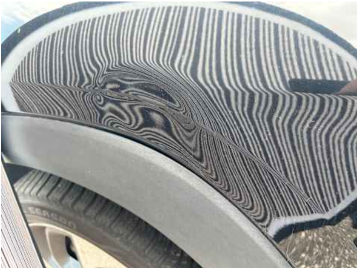
Kotflügel vorne links (Verformung)
