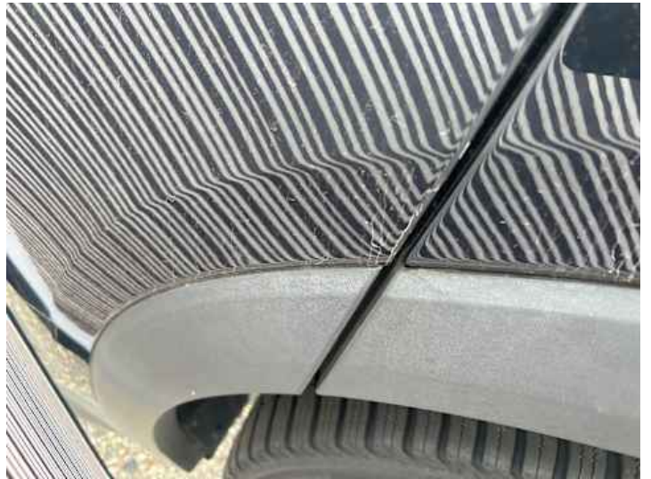
Türe hinten links (Delle)
