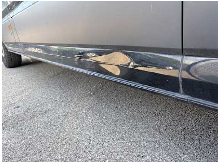
Seitenteil hinten links (Verformung, Kratzer)
