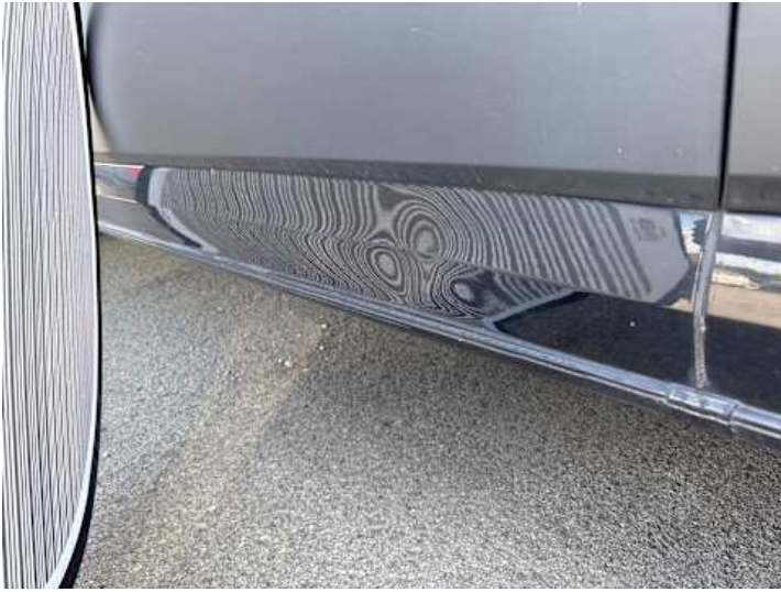
Seitenteil hinten links (Verformung, Kratzer)
