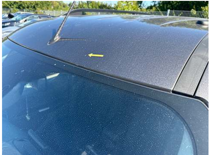
Dach (Lackschaden, Steinschlag)
