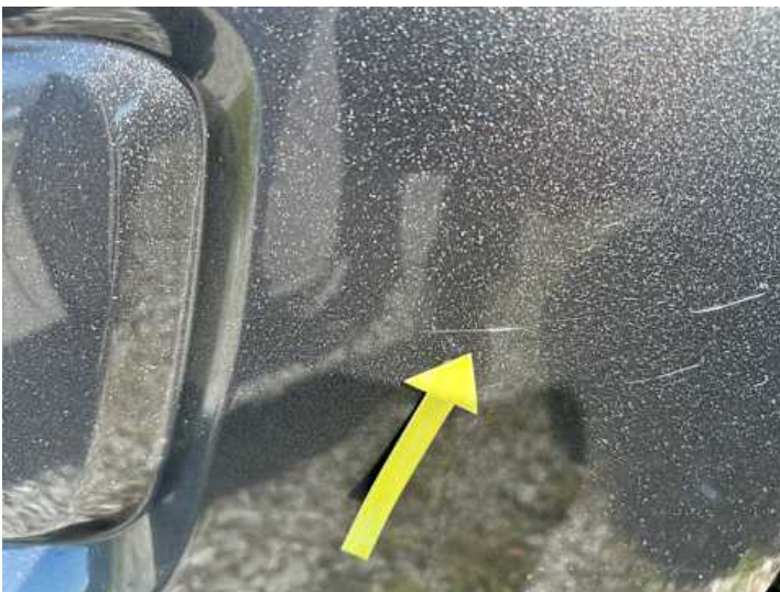
Stoßstange vorne (Kratzer)
