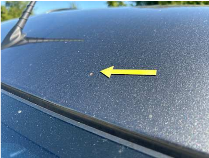
Dach (Lackschaden, Steinschlag)
