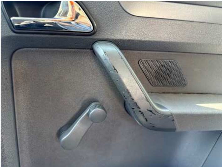
Innenraum (Verschmutzung, Verschleiß, Kratzer)
