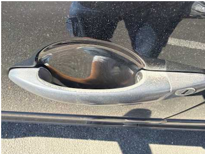
Fahrtür (Lackschaden, Kratzer)
