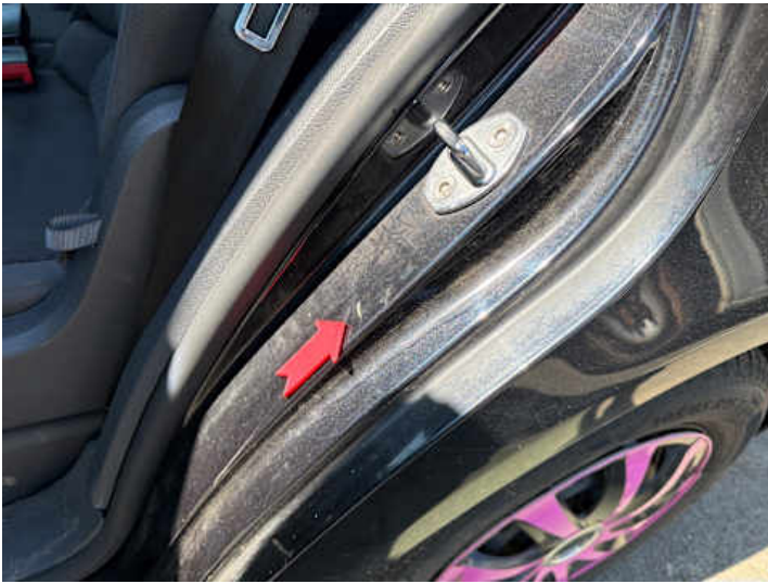
Seitenteil hinten links (Kratzer, Delle)
