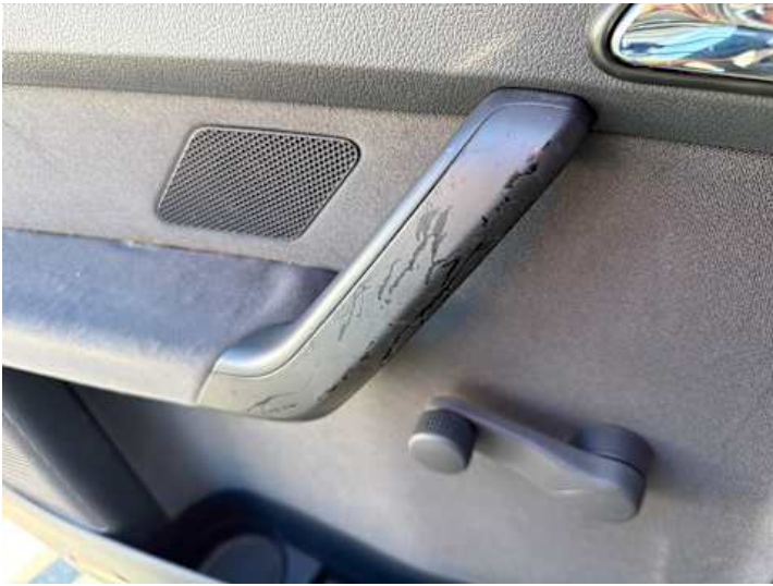
Innenraum (Verschmutzung, Verschleiß, Kratzer)
