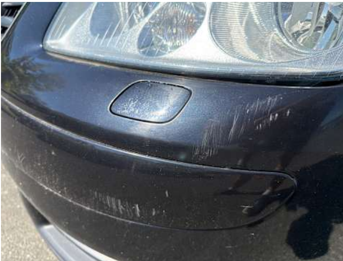
Stoßstange vorne (Kratzer, Lackschaden)
