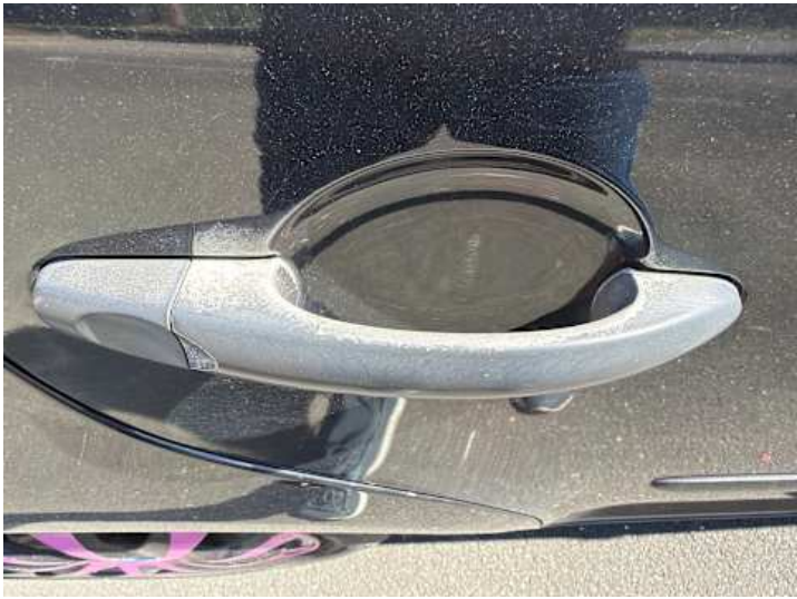
Türe hinten rechts (Kratzer, Lackschaden)
