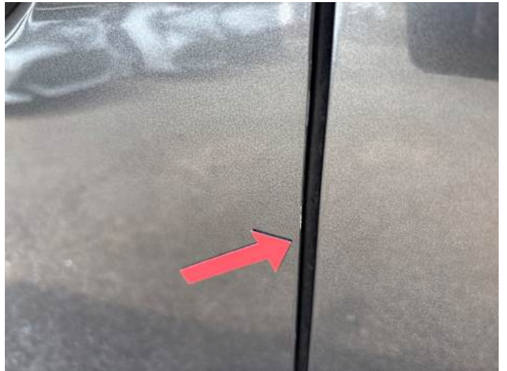
Fahrtür (Delle, Kratzer)
