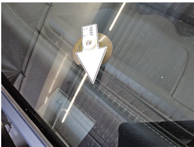
Windschutzscheibe kleine Steinschläge (DEKRA)
