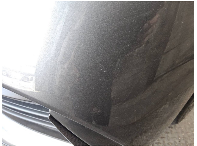
Vorderwagen kleine Steinschläge Vorderwagen kleine Steinschläge (DEKRA)
