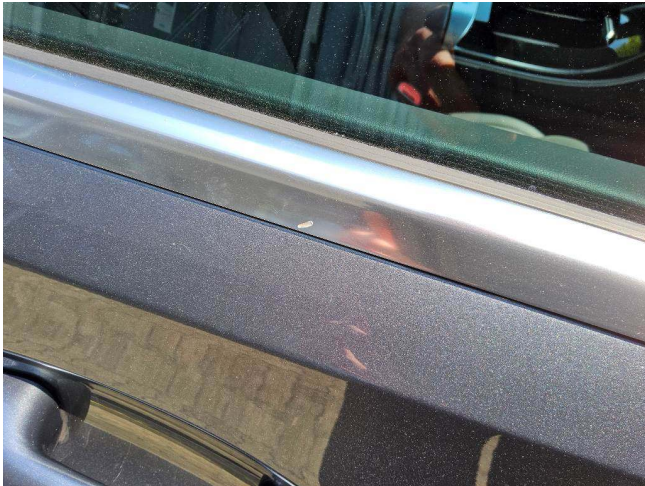
Schachtleiste Tür vorne rechts zerkratzt - erneuern Schachtleiste Tür vorne rechts zerkratzt (DEKRA)
