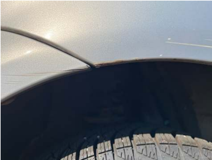
Seitenteil hinten rechts (Kratzer, Rost, Delle)
