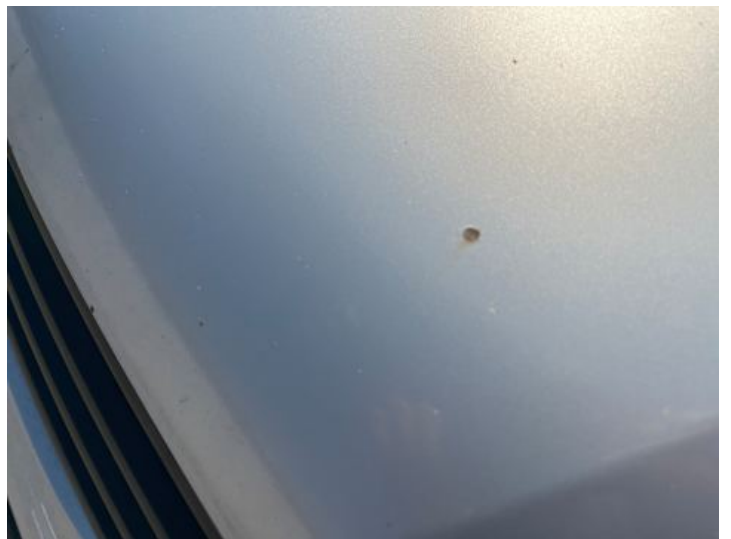
Motorhaube (Steinschlag, Rost)
