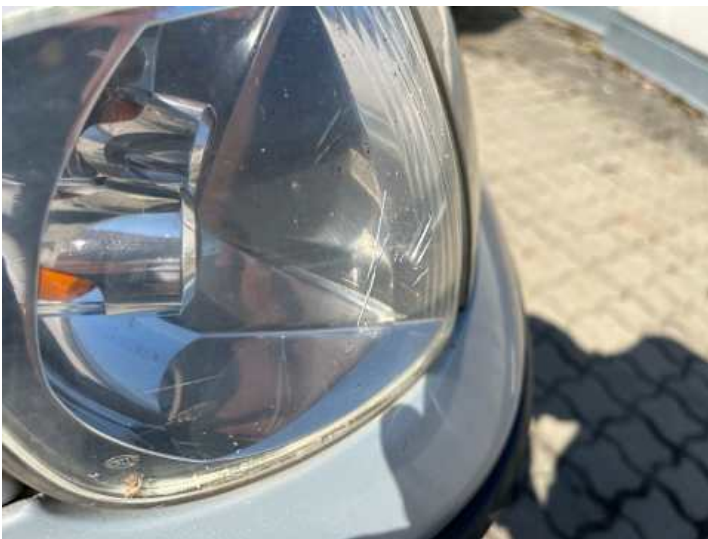
Scheinwerfer (rechts) (Riss/Bruch)
