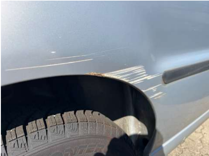
Seitenteil hinten rechts (Kratzer, Rost, Delle)
