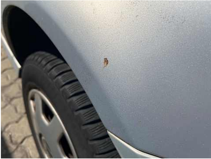
Kotflügel vorne rechts (Lackschaden, Rost)
