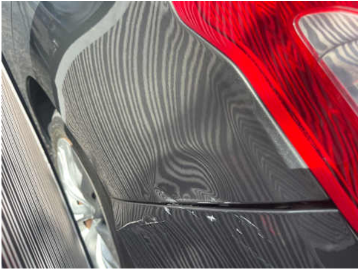
Seitenteil hinten links (Verformung)
