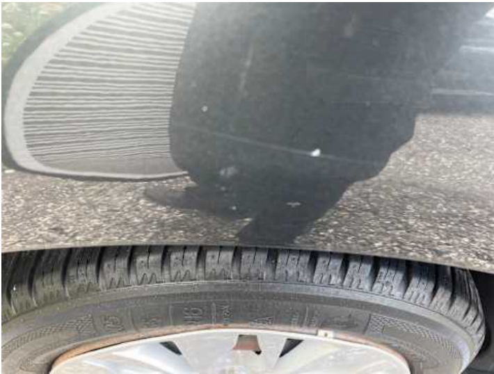
Seitenteil hinten rechts (Lackschaden)
