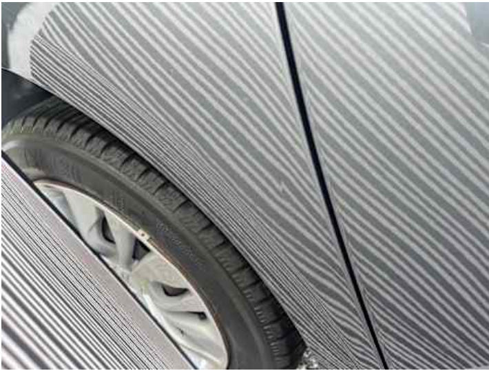
Seitenteil hinten rechts (Delle)
