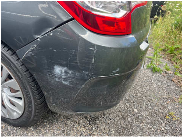
Stoßstange hinten (Kratzer, Lackschaden, Spaltmaße ungenau, Riss/Bruch)
