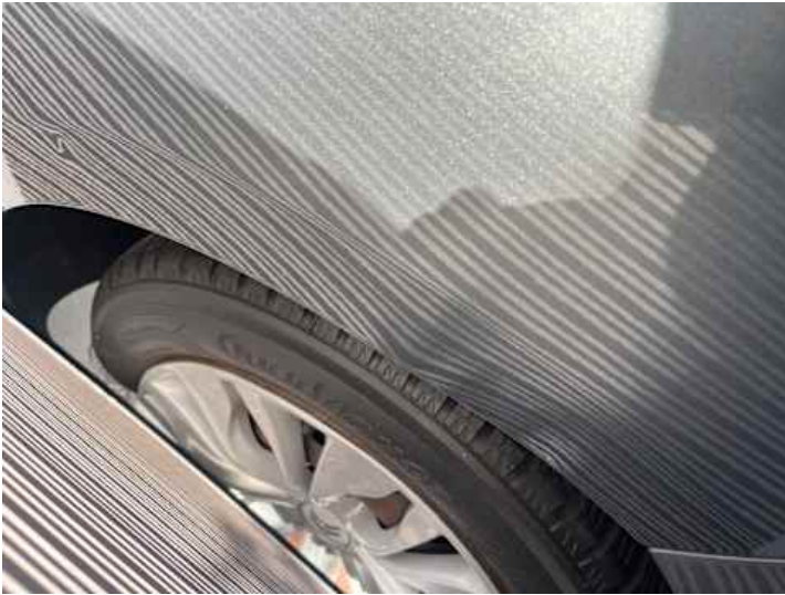
Seitenteil hinten links (Verformung)
