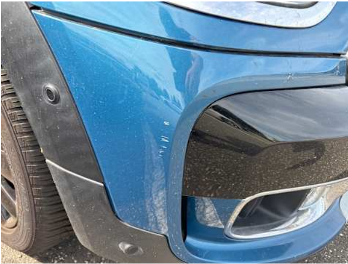
Stoßstange vorne (Kratzer, Lackschaden)
