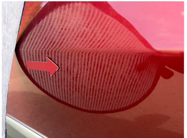
Fahrtür (Kratzer, Delle)
