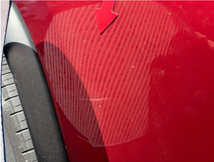
Türe hinten rechts (Kratzer, Delle)
