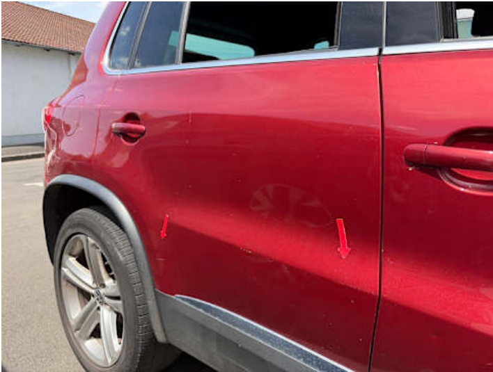
Türe hinten rechts (Kratzer, Delle)
