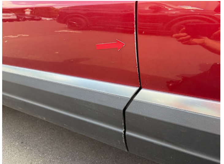
Fahrtür (Kratzer, Delle)
