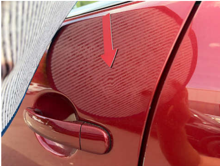
Fahrtür (Kratzer, Delle)
