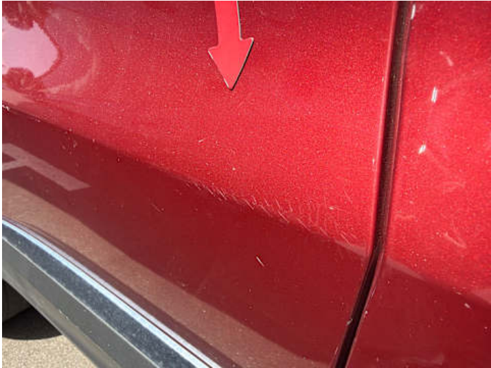
Türe hinten rechts (Kratzer, Delle)
