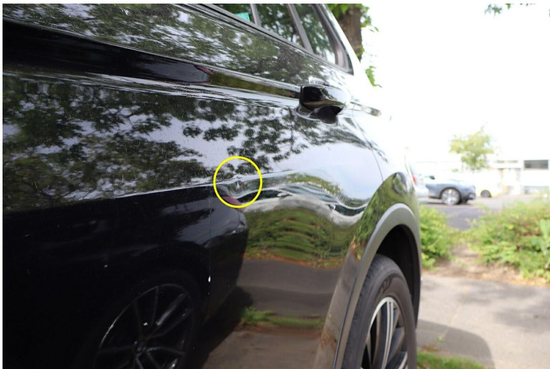
Bild 14 : Tür hinten links eingedellt
