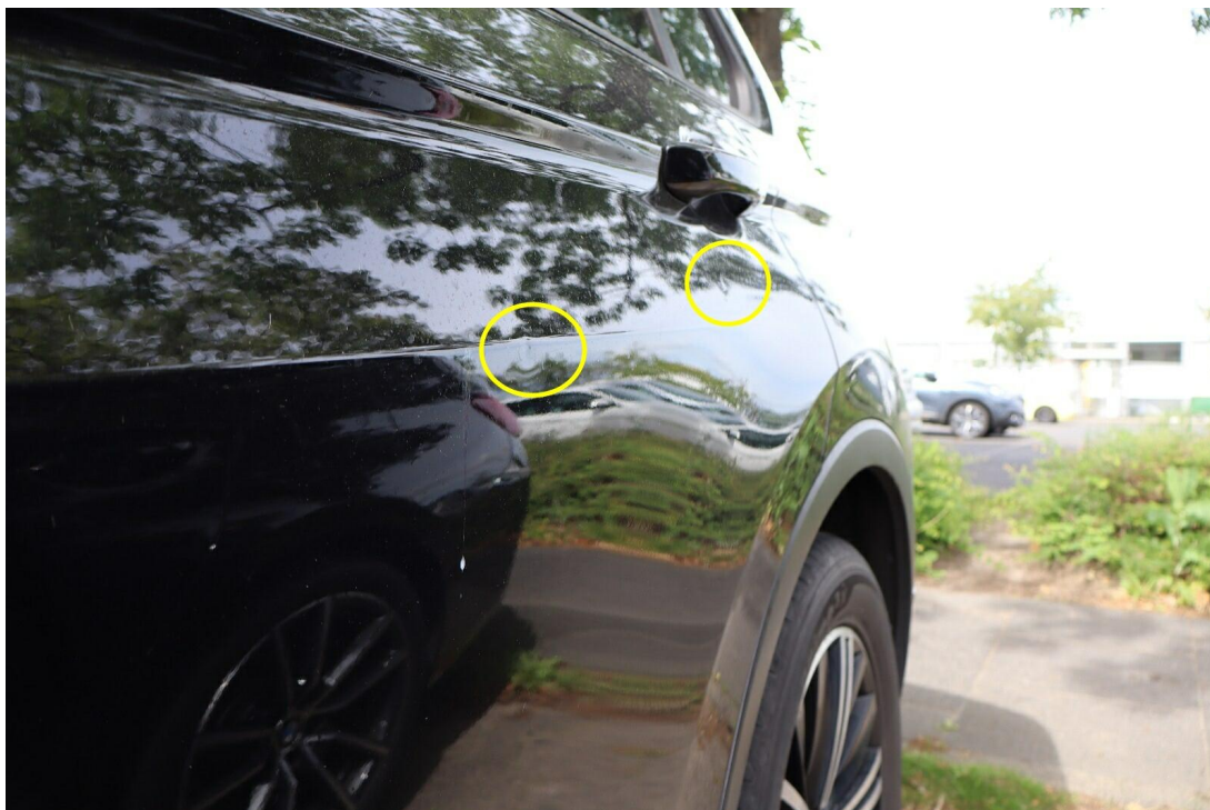
Bild 13 : Tür hinten links eingedellt
