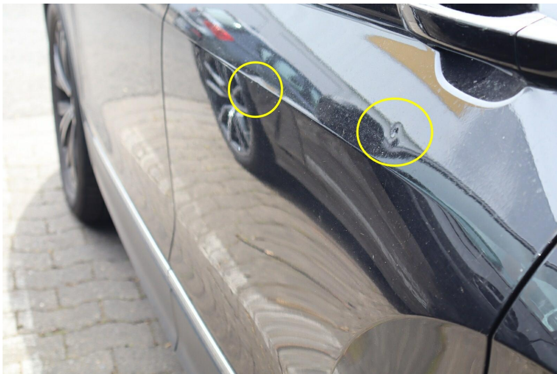
Bild 12 : Tür hinten links eingedellt
