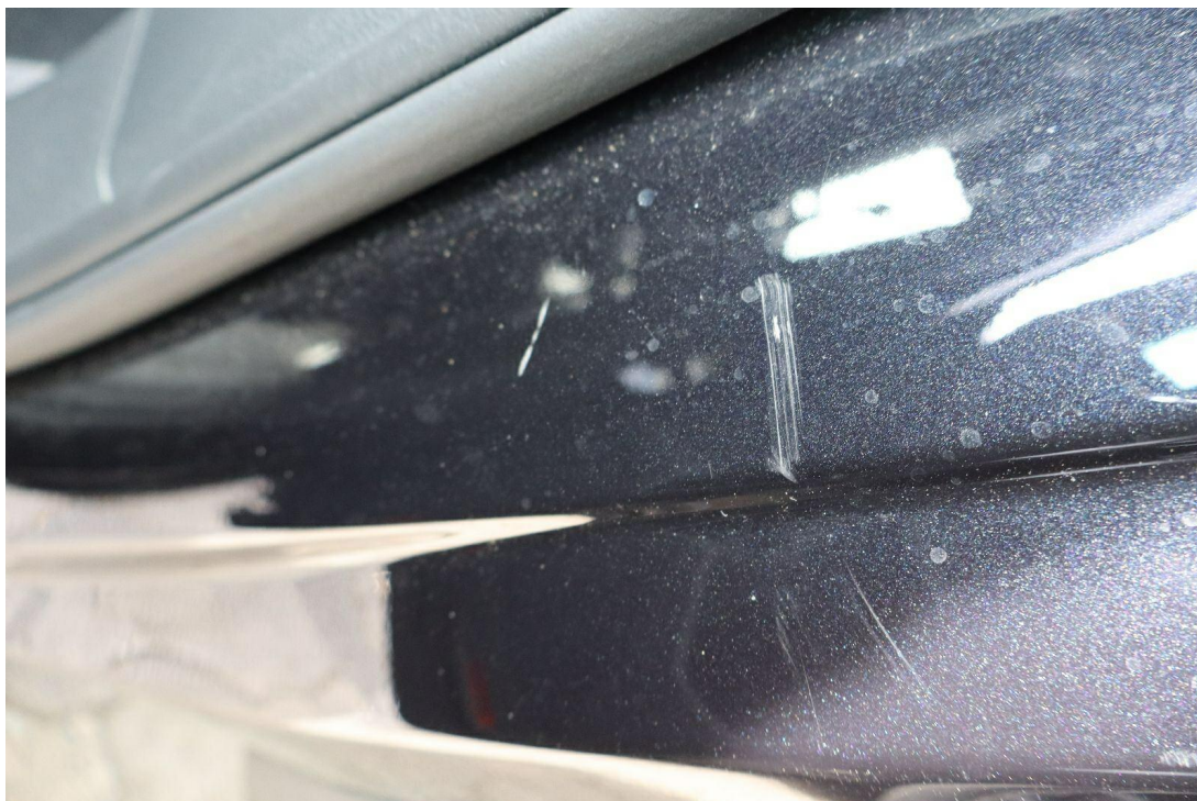
Bild 9 : Einstieg hinten links verschrammt
