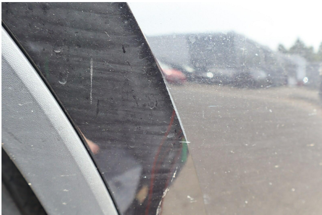
Bild 11 : Stoßfängerverkleidung vorn rechtsseitig verschrammt
