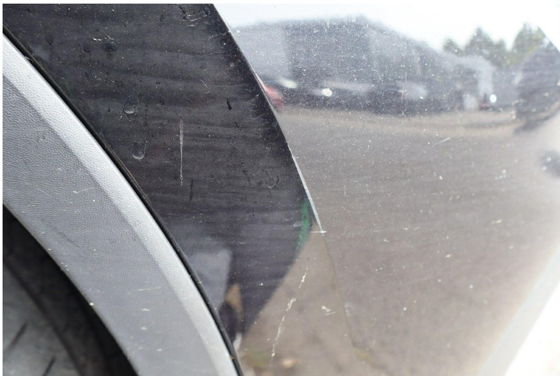
Bild 10 : Stoßfängerverkleidung vorn rechtsseitig verschrammt
