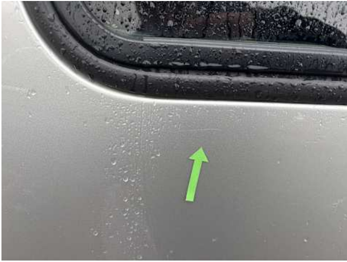
Türe hinten links (Lackschaden, Kratzer)
