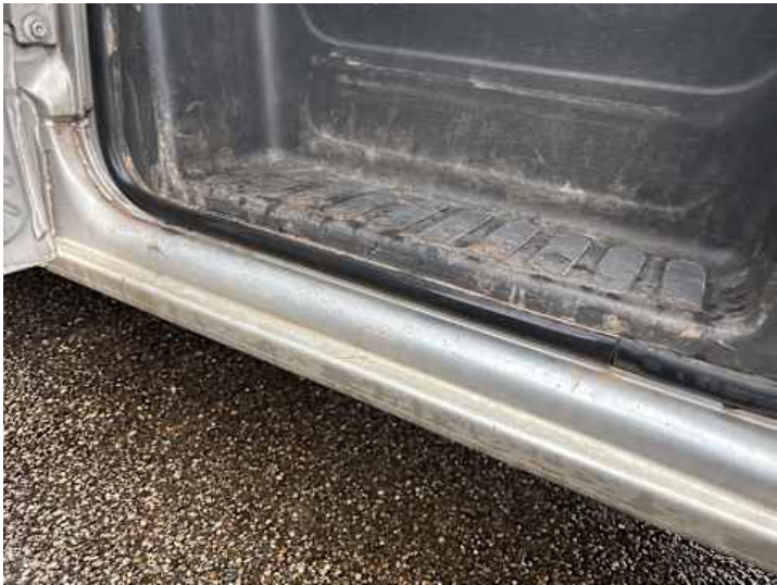
Schweller links (Lackschaden)
