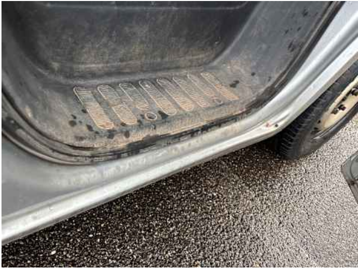
Schweller rechts (Lackschaden)
