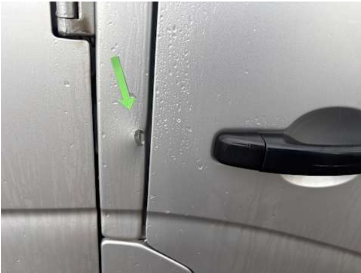
Beifahrertür (Lackschaden, Delle)
