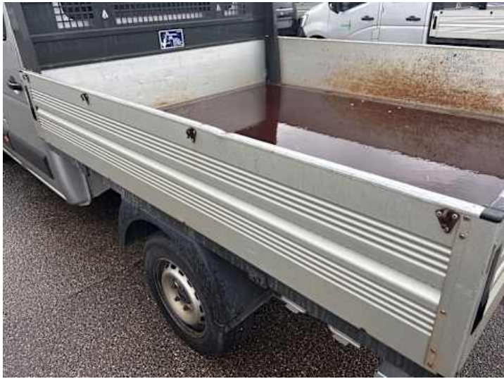
Seitenteil hinten links (Lackschaden, Delle)
