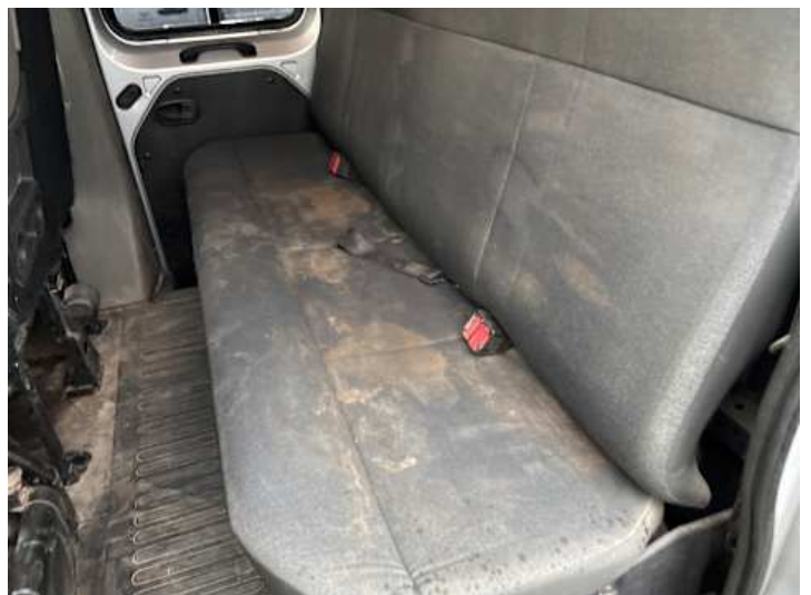
Innenraum (Verschleiß, Verschmutzung)
