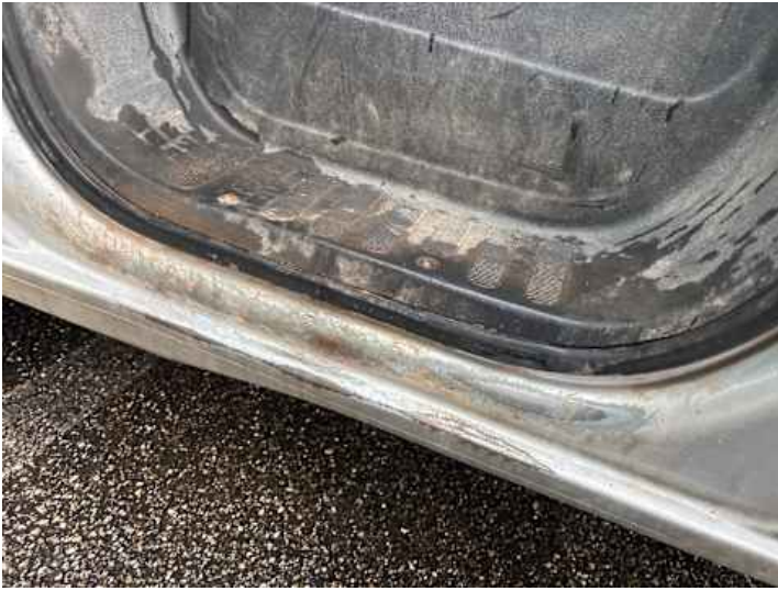
Schweller links (Lackschaden)
