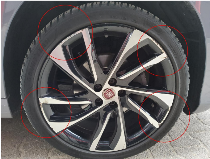
Bild 1: Außen, Felge vorne rechts, verschrammt, erneuern
