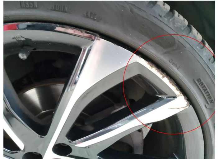
Bild 2: Außen, Felge vorne rechts, verschrammt, erneuern
