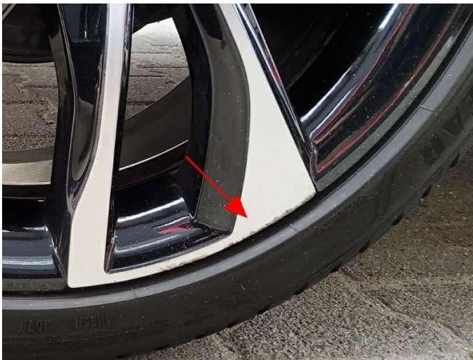
Bild 5: Außen, Felge hinten rechts, verschrammt, Minderwert
