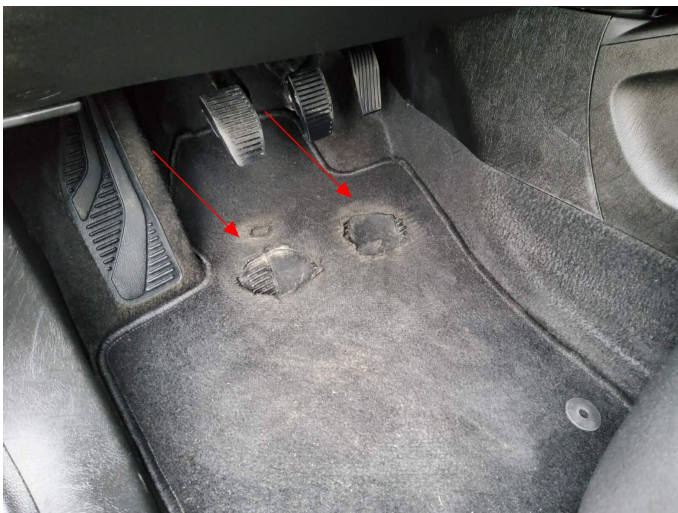
Bild 7: Innen, Bodenbelag vorne - Fußmatte links, gerissen, erneuern
