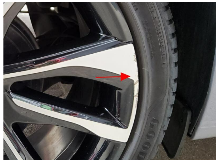
Bild 4: Außen, Felge hinten rechts, verschrammt, Minderwert
