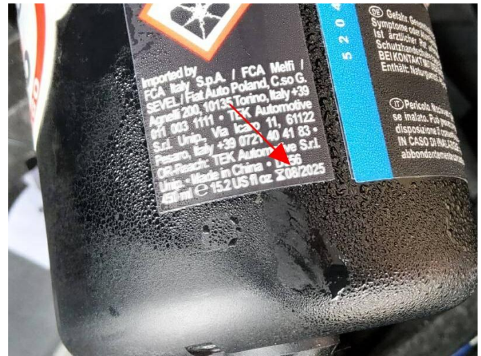
Bild 6: Außen, Reifen Ersatzrad - Füllflasche, überfällig, erneuern
