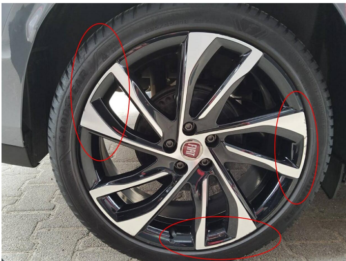
Bild 3: Außen, Felge hinten rechts, verschrammt, Minderwert
