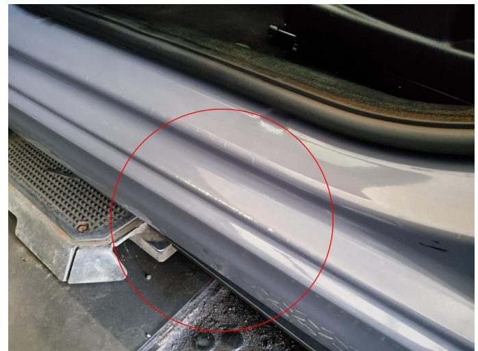
Bild 8: Außen, Tür vorne links - Einstieg Lackierung, verschrammt, Lackieren
