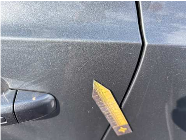
Türe hinten links (Kratzer)
