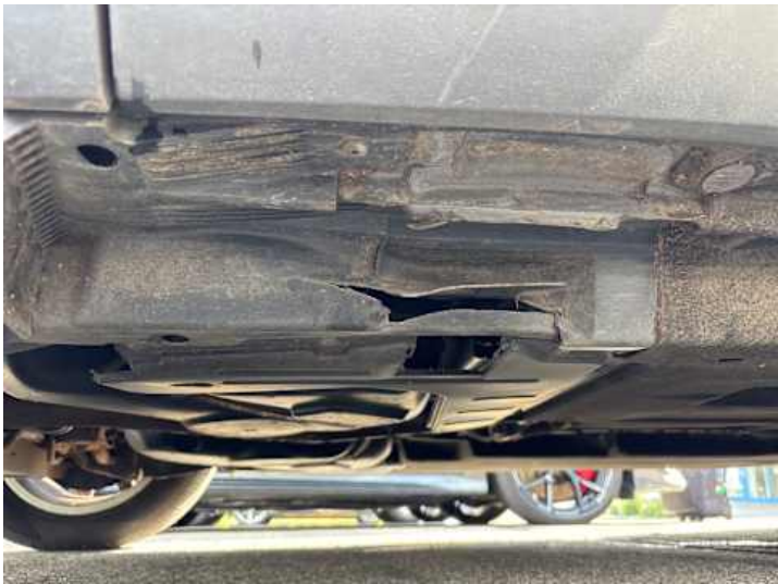
Schweller rechts (Riss/Bruch)
