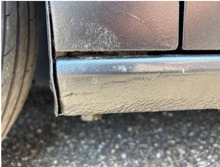
Schweller links (Rost, Unsachgemäß instand gesetzt)
