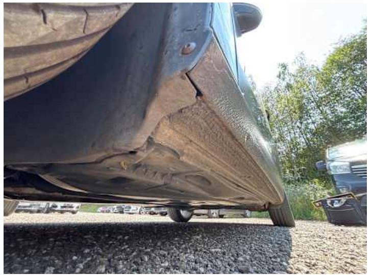
Schweller links (Rost, Unsachgemäß instand gesetzt)
