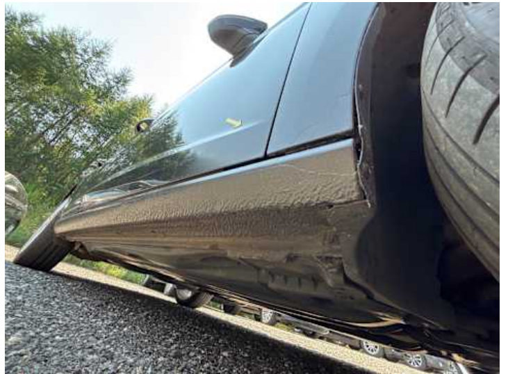
Schweller rechts (Rost, Unsachgemäß instand gesetzt)
