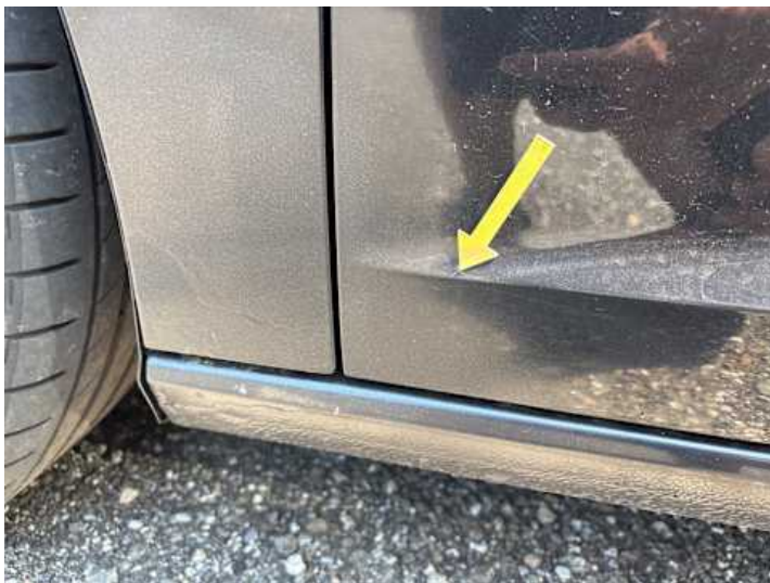
Fahrertür (Unsachgemäß instand gesetzt)
