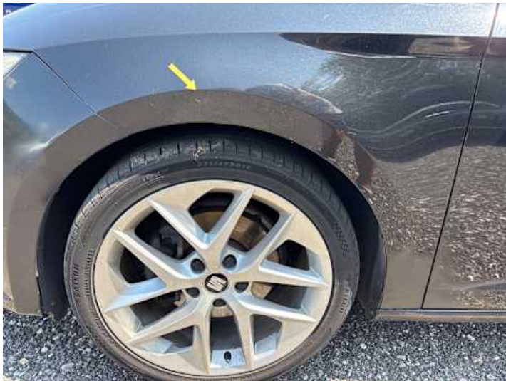
Kotflügel vorne links (Rost, Unsachgemäß instand gesetzt)
