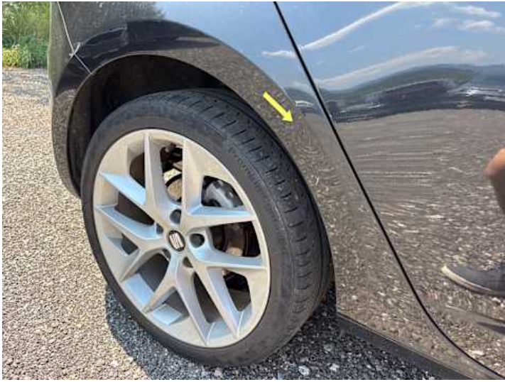
Seitenteil hinten rechts (Delle, Rost)
