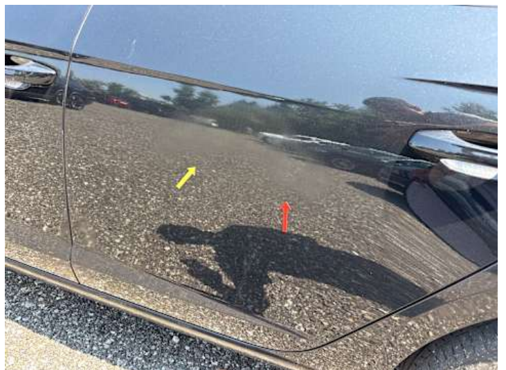
Türe hinten links (Unsachgemäß instand gesetzt)
