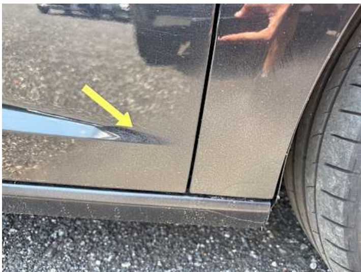
Beifahrertür (Unsachgemäß instand gesetzt, Rost)
