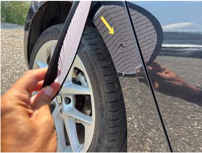
Seitenteil hinten rechts (Delle, Rost)
