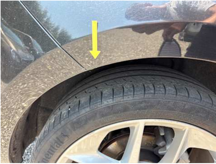
Seitenteil hinten rechts (Delle, Rost)
