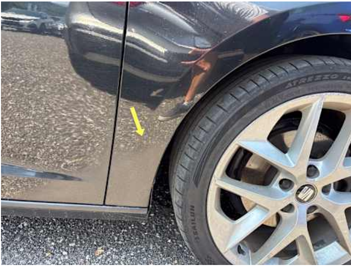
Kotflügel vorne rechts (Unsachgemäß instand gesetzt, Rost)
