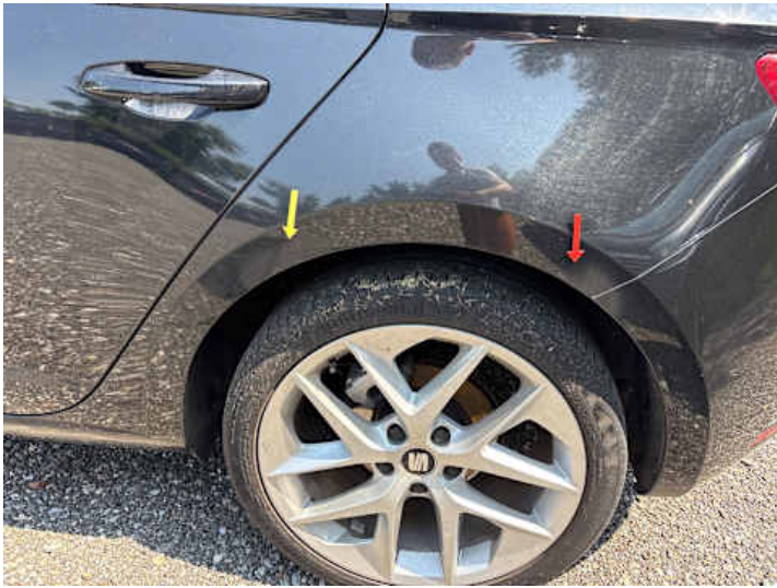
Seitenteil hinten links (Rost, Unsachgemäß instand gesetzt)
