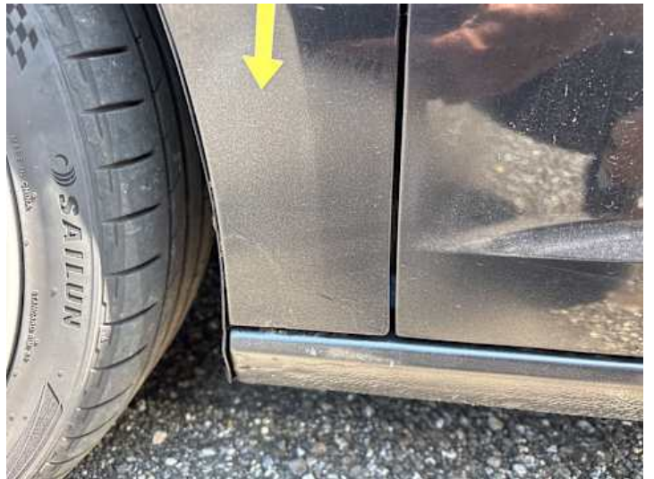
Kotflügel vorne links (Rost, Unsachgemäß instand gesetzt)
