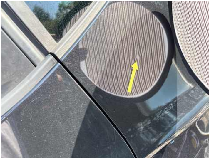
Seitenteil hinten links (Delle)
