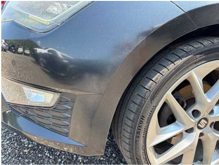
Stoßstange vorne (Unsachgemäß instand gesetzt)
