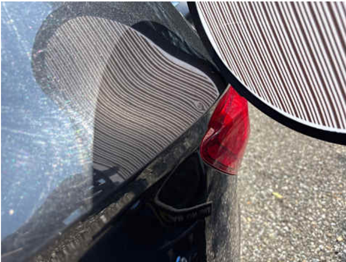
Seitenteil hinten links (Delle)
