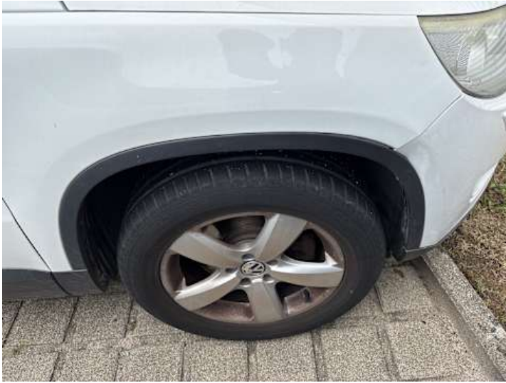
Kotflügel vorne rechts (Spaltmaße ungenau)
