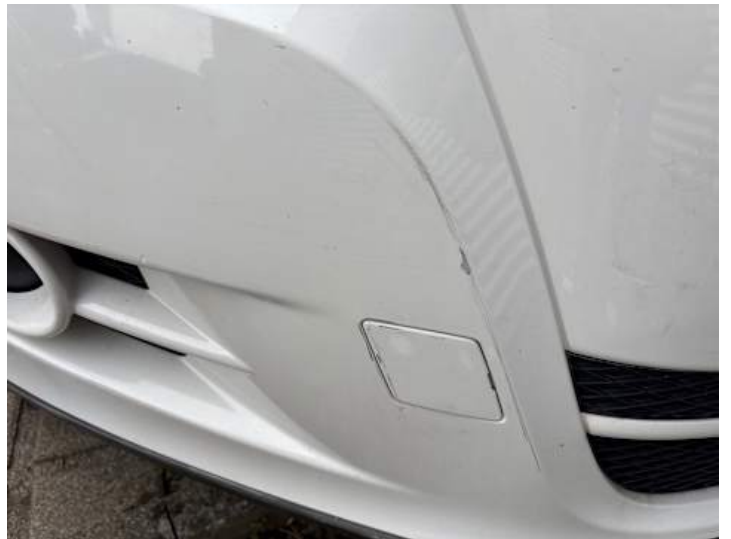
Stoßstange vorne (Kratzer, Lackschaden)
