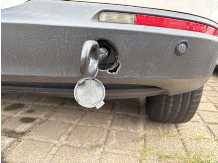
Stoßstange hinten (Kratzer, Riss/Bruch, Lackschaden)
