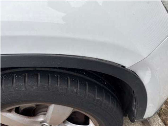
Kotflügel vorne rechts (Spaltmaße ungenau)
