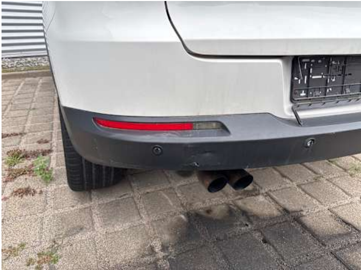
Stoßstange hinten (Kratzer, Riss/Bruch, Lackschaden)
