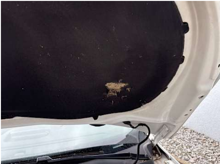
Motorhaube (Anderer Schaden): Marderspuren
