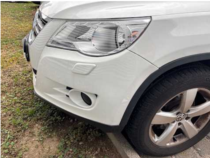
Stoßstange vorne (Spaltmaße ungenau)
