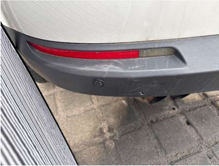
Stoßstange hinten (Kratzer, Riss/Bruch, Lackschaden)
