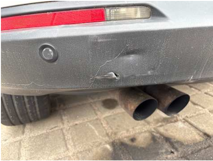
Stoßstange hinten (Kratzer, Riss/Bruch, Lackschaden)
