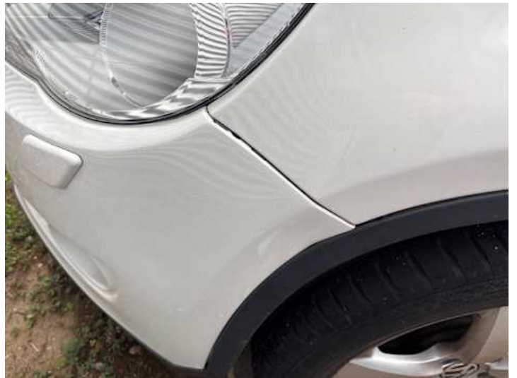
Stoßstange vorne (Spaltmaße ungenau)
