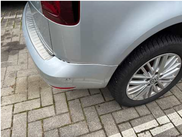
Stoßstange hinten (Lackschaden, Spaltmaße ungenau)
