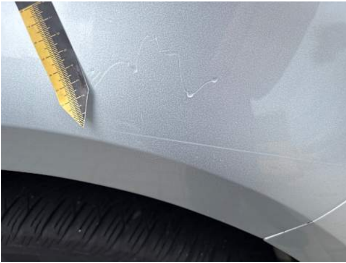
Kotflügel vorne rechts (Kratzer)
