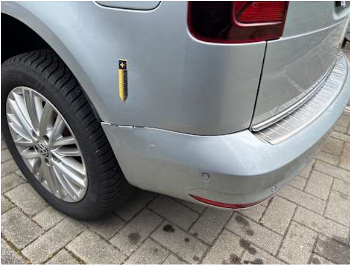
Stoßstange hinten (Spaltmaße ungenau, Lackschaden, Verformung)
