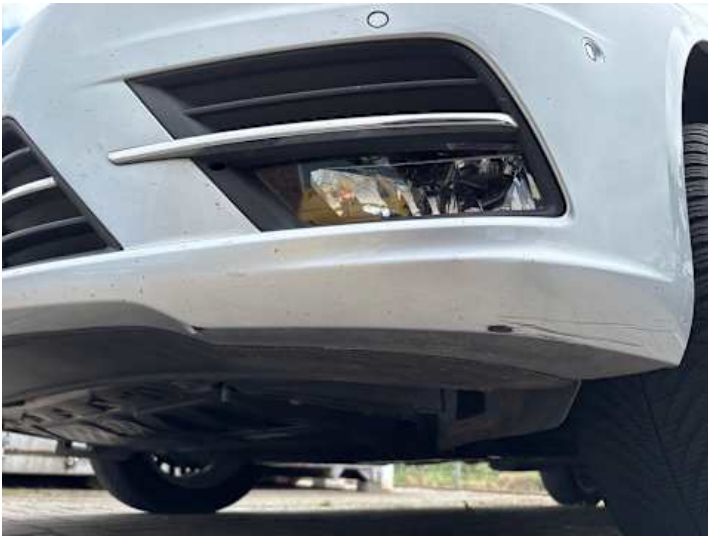
Stoßstange vorne (Kratzer, Lackschaden)
