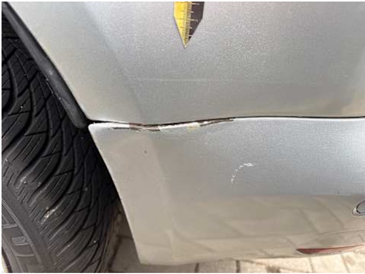
Stoßstange hinten (Spaltmaße ungenau, Lackschaden, Verformung)
