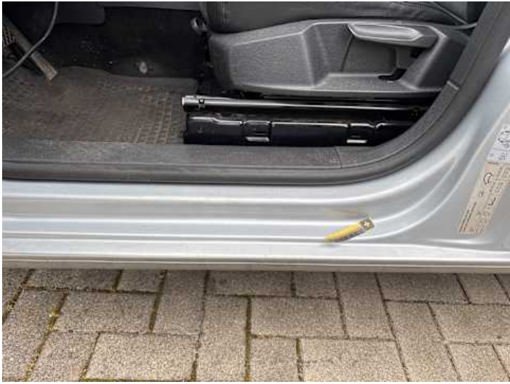
Schweller links (Kratzer)
