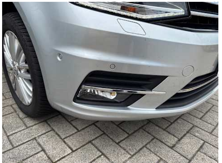
Stoßstange vorne (Kratzer, Lackschaden)
