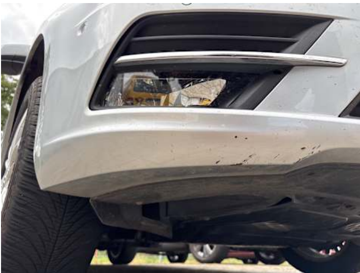
Stoßstange vorne (Kratzer, Lackschaden)
