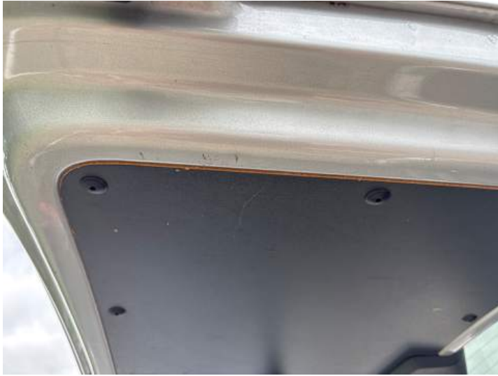
Heckklappe (Delle, Lackschaden)
