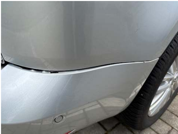
Stoßstange hinten (Lackschaden, Spaltmaße ungenau)
