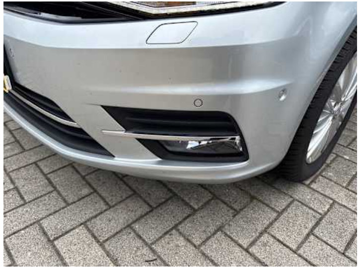
Stoßstange vorne (Kratzer, Lackschaden)
