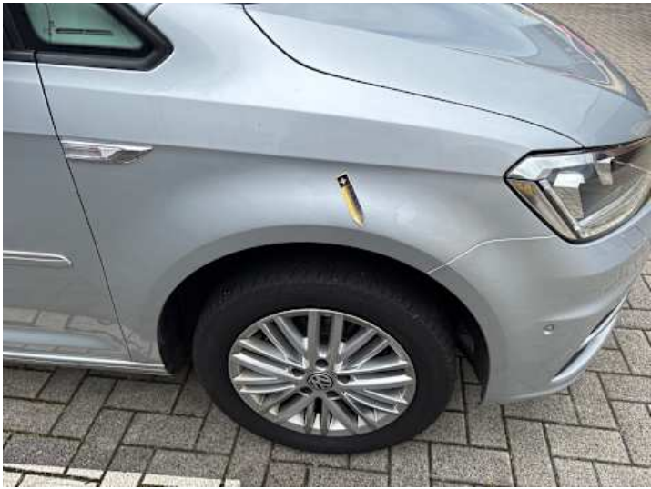
Kotflügel vorne rechts (Kratzer)
