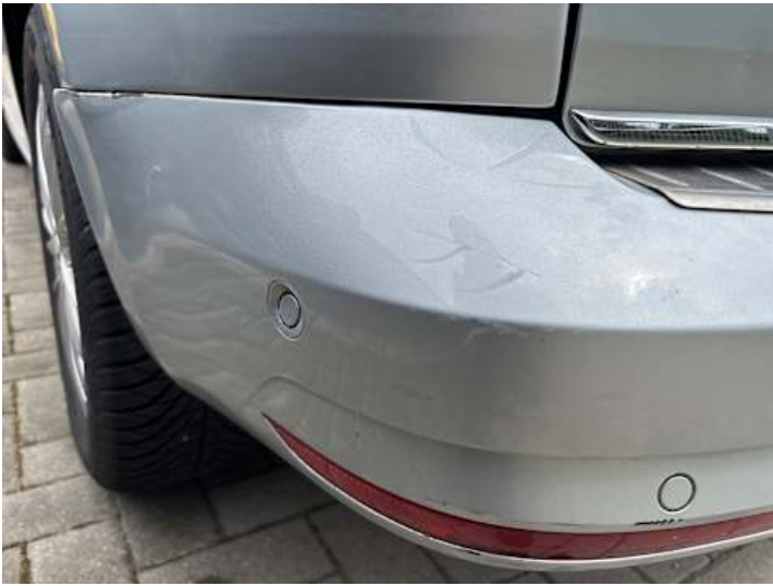
Stoßstange hinten (Spaltmaße ungenau, Lackschaden, Verformung)
