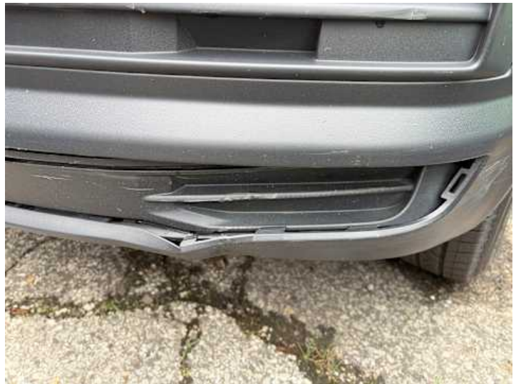
Stoßstange vorne (Riss/Bruch)
