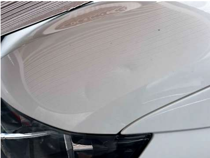
Motorhaube (Verformung, Delle)
