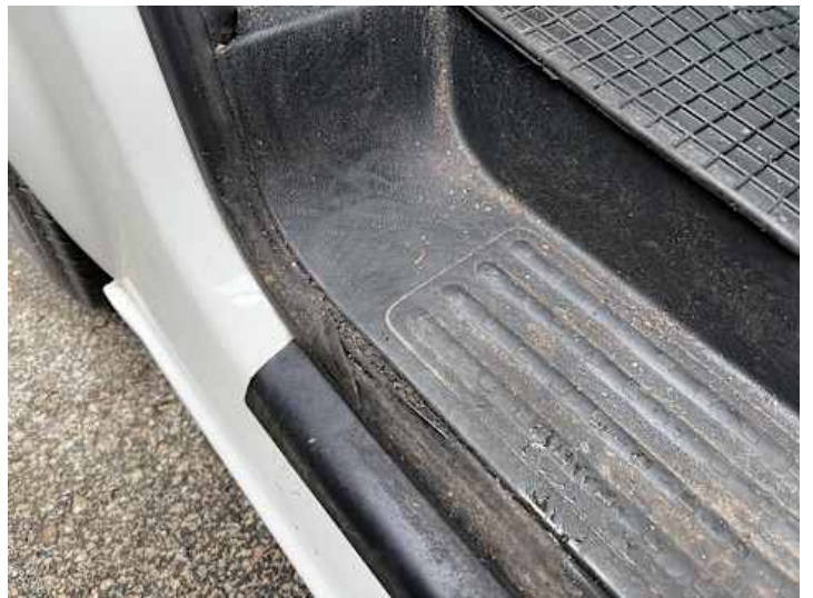
Fahrtür (Anderer Schaden): Gummidichtung löst sich
