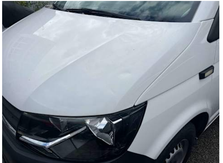
Motorhaube (Verformung, Delle)
