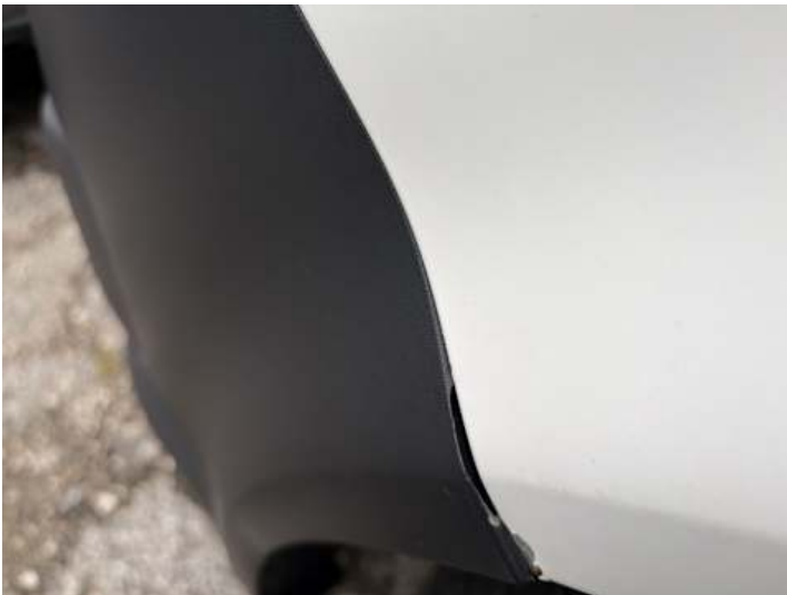
Stoßstange vorne (Riss/Bruch)
