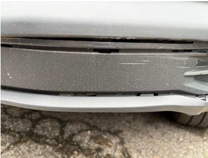
Stoßstange vorne (Riss/Bruch)
