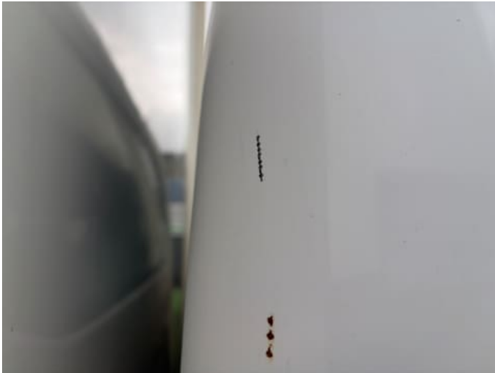
Seitenteil hinten rechts (Lackschaden, Rost)
