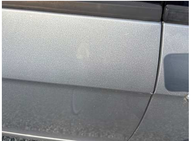
Türe hinten rechts (Kratzer, Ausgeblichen/Matt)
