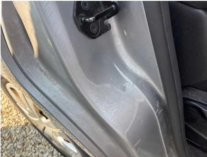
Türe hinten rechts (Kratzer, Delle)
