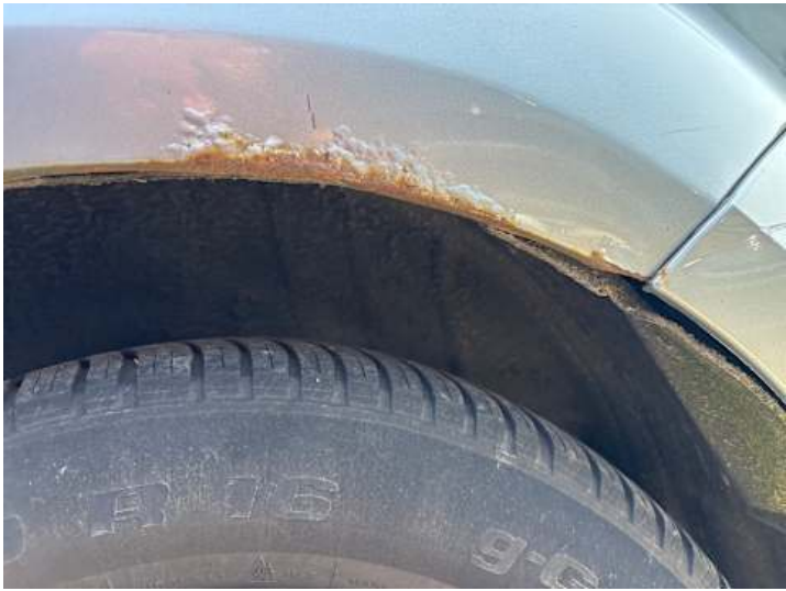
Seitenteil hinten links (Rost, Kratzer)
