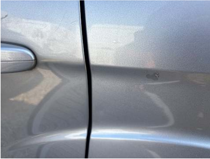
Seitenteil hinten links (Lackschaden)
