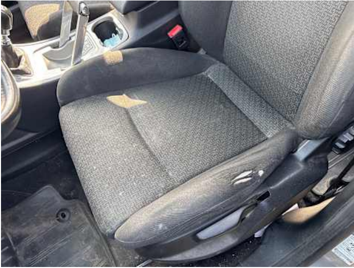
Innenraum (Riss/Bruch, Verschmutzung, Brandloch)
