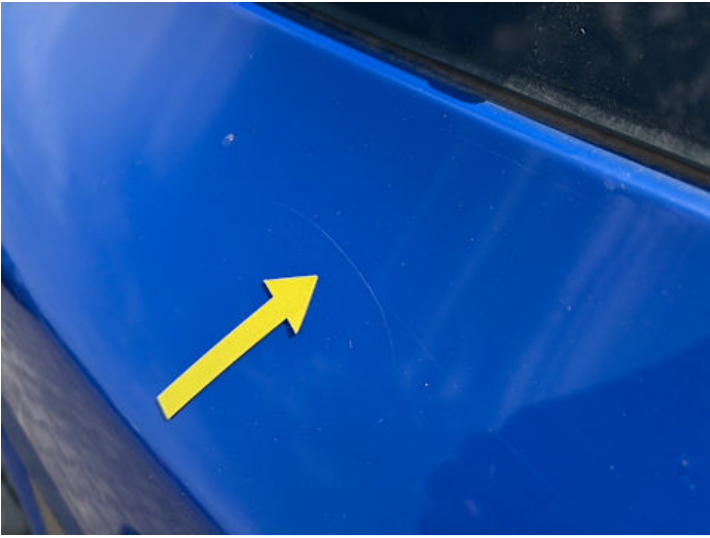
Heckklappe (Kratzer, Rost)
