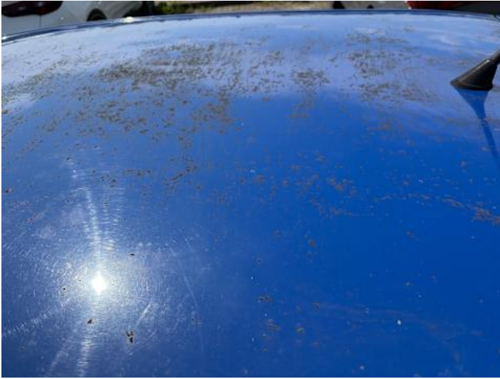
Dach (Anderer Schaden): Verschmutzung
