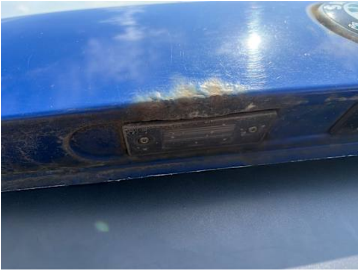
Heckklappe (Kratzer, Rost)
