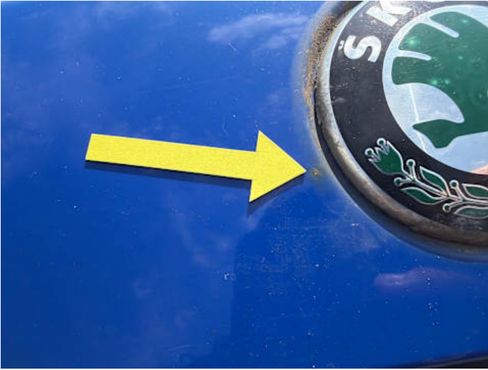
Heckklappe (Kratzer, Rost)
