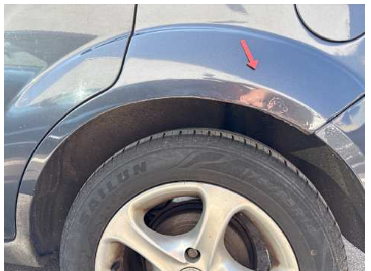
Seitenteil hinten links (Rost, Unsachgemäß instand gesetzt)
