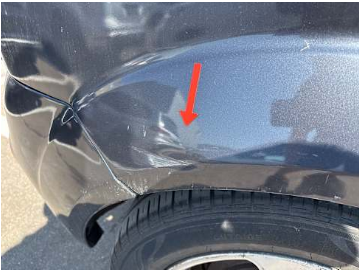
Seitenteil hinten rechts (Kratzer, Lackschaden, Verformung)
