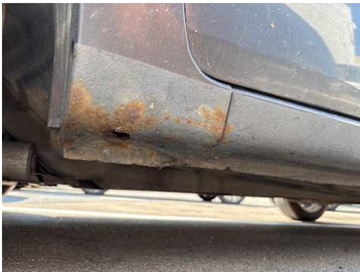
Schweller links (Rost)
