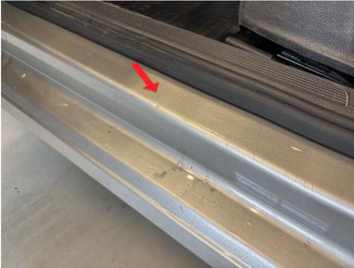
Schweller links (Kratzer, Delle)
