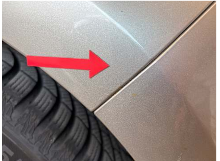
Seitenteil hinten links (Rost)
