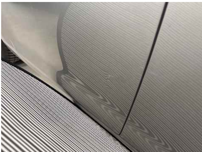
Türe hinten rechts (Verformung)
