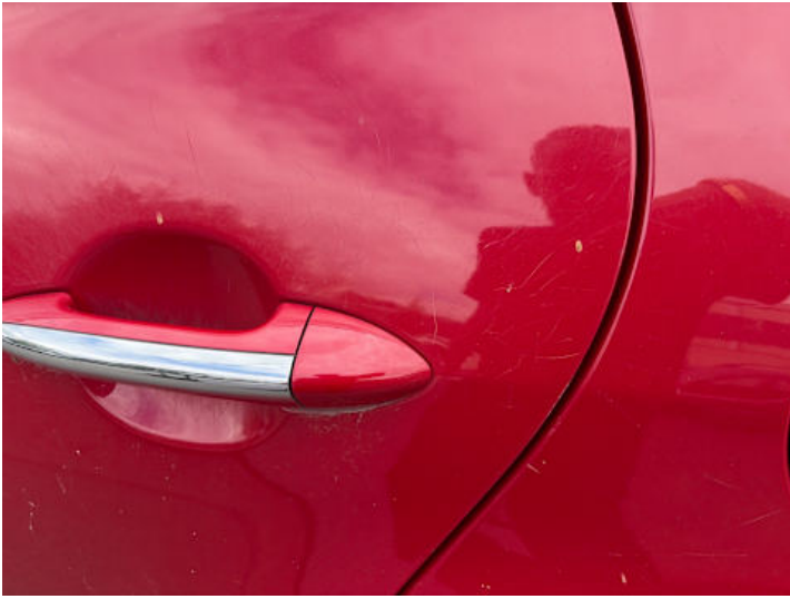
Türe hinten links (Lackschaden, Kratzer)
