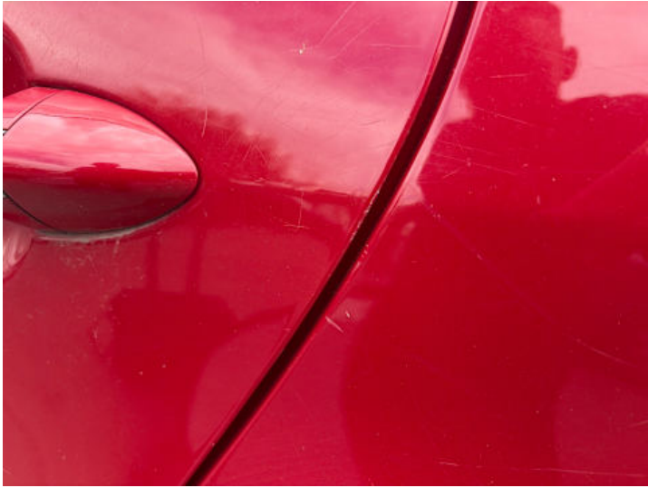
Türe hinten links (Lackschaden, Kratzer)
