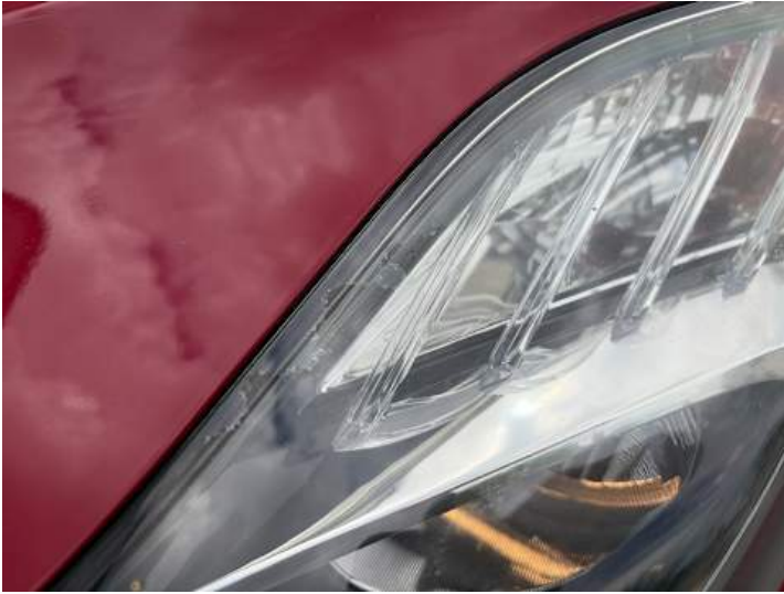
Scheinwerfer (links) (Anderer Schaden): Lack blättert ab
