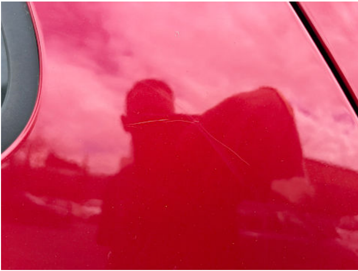
Seitenteil hinten links (Lackschaden, Kratzer)
