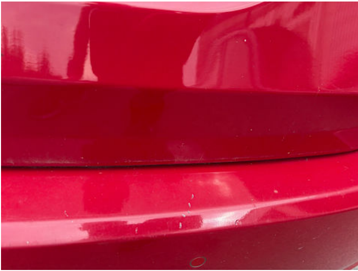
Heckklappe (Lackschaden, Kratzer)
