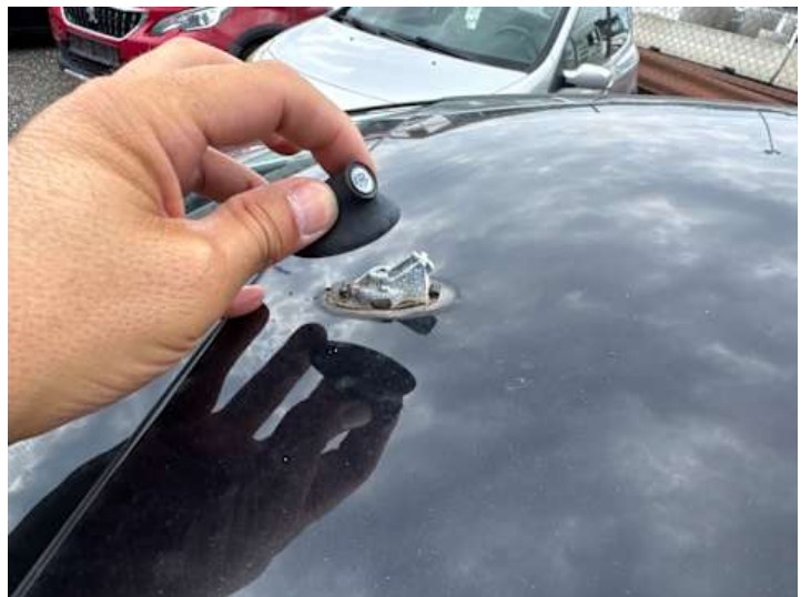
Dach (Anderer Schaden): Antenne lose
