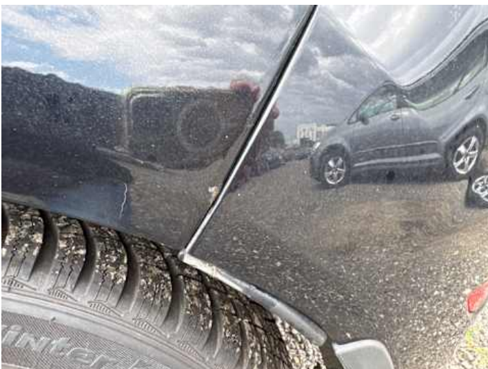
Seitenteil hinten links (Rost)
