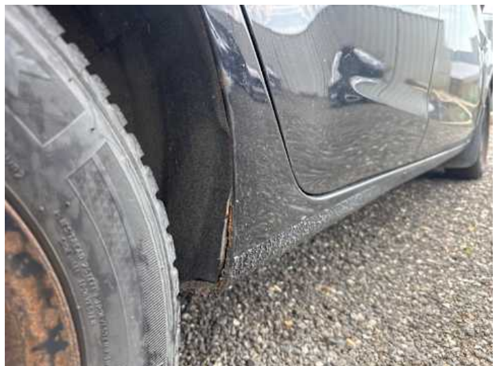
Seitenteil hinten rechts (Rost)
