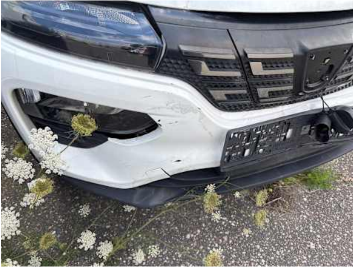
Stoßstange vorne (Verformung, Riss/Bruch)
