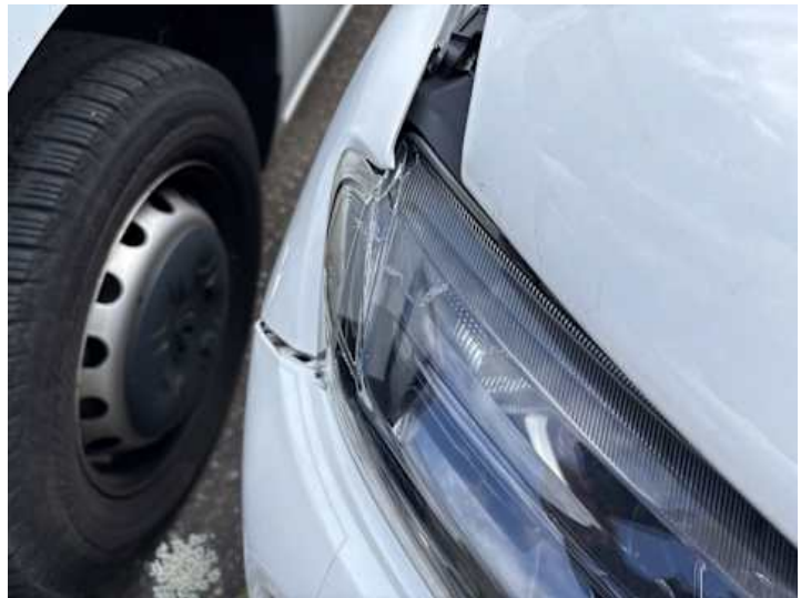
Scheinwerfer (rechts) (Riss/Bruch)
