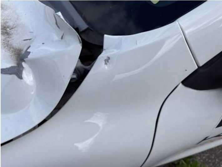
Kotflügel vorne links (Verformung)
