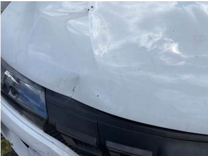
Motorhaube (Verformung, Lackschaden)
