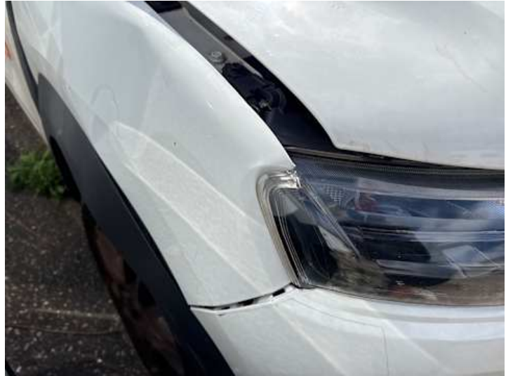
Kotflügel vorne rechts (Verformung)
