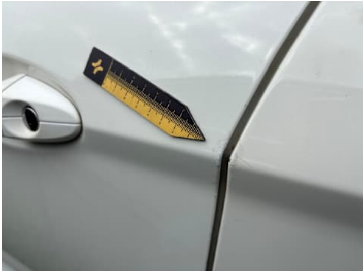
Fahrtür (Lackschaden, Unsachgemäß instand gesetzt)
