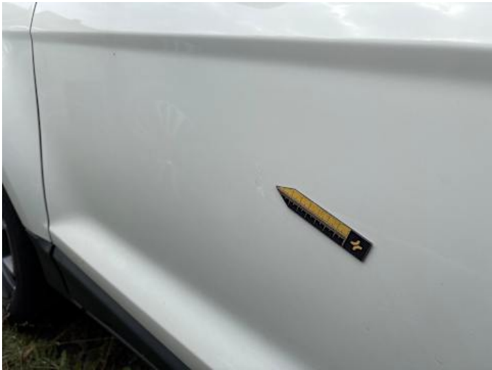
Fahrtür (Lackschaden, Unsachgemäß instand gesetzt)
