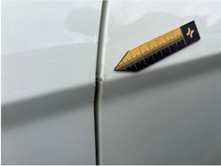
Türe hinten links (Kratzer, Unsachgemäß instand gesetzt)
