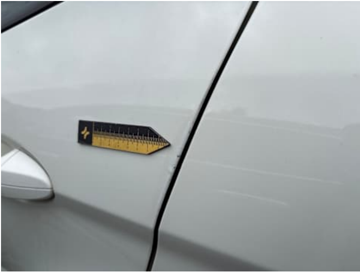
Türe hinten links (Kratzer, Unsachgemäß instand gesetzt)
