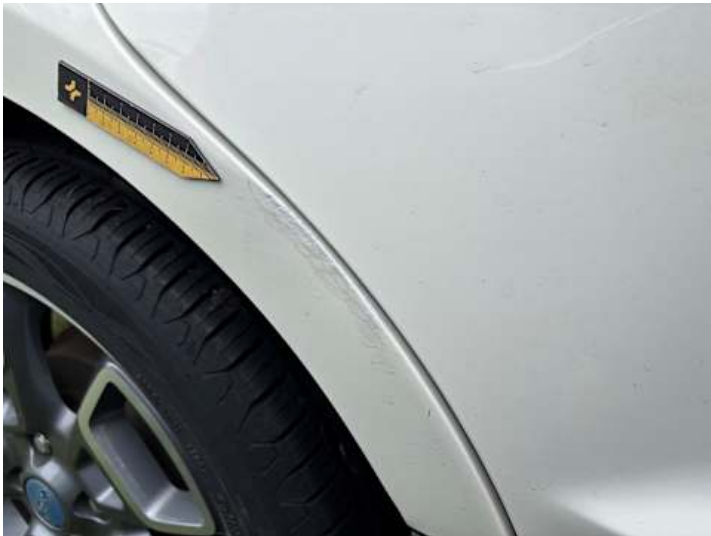
Seitenteil hinten rechts (Kratzer, Unsachgemäß instand gesetzt)
