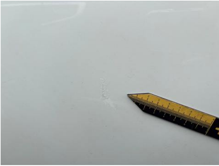
Fahrtür (Lackschaden, Unsachgemäß instand gesetzt)
