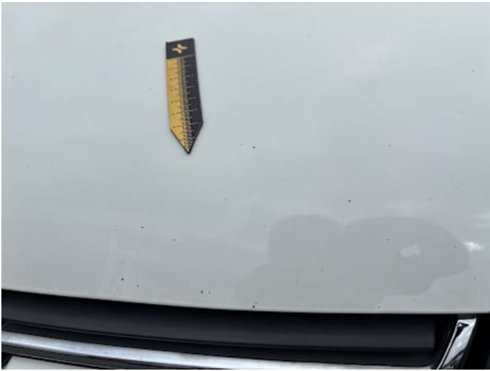
Motorhaube (Steinschlag, Rost)
