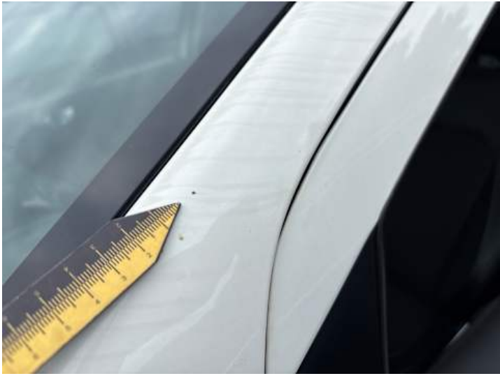
Dach (Steinschlag, Rost)
