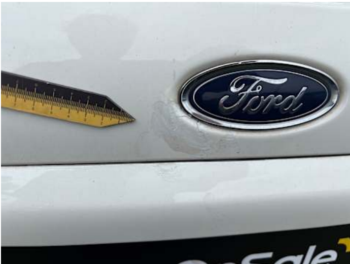
Heckklappe (Unsachgemäß instand gesetzt, Lackschaden)
