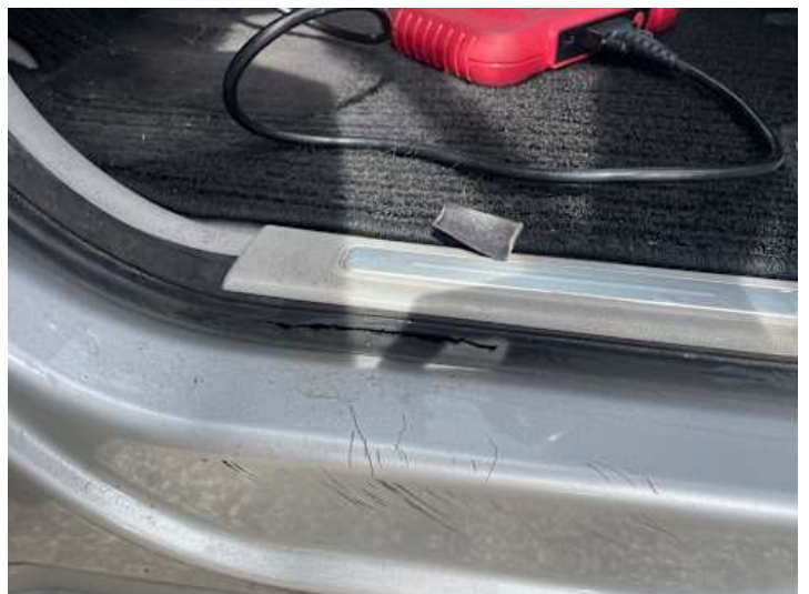
Schweller links (Kratzer, Riss/Bruch)
