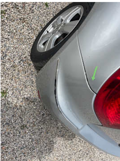
Stoßstange hinten (Spaltmaße ungenau)
