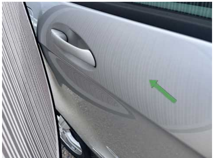
Türe hinten rechts (Delle)
