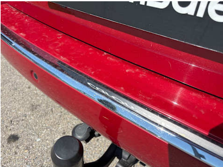
Stoßstange hinten (Kratzer, Riss/Bruch)
