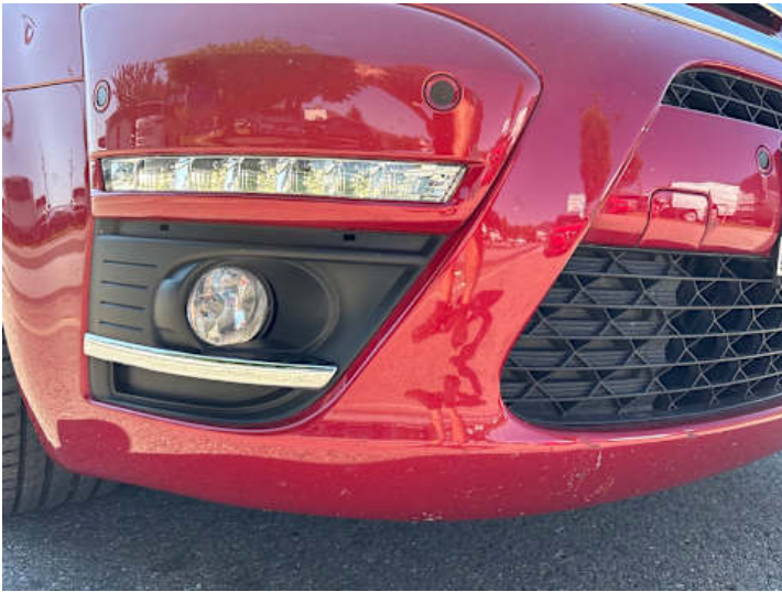
Stoßstange vorne (Kratzer, Lackschaden)
