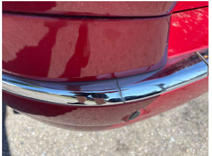
Stoßstange hinten (Kratzer, Riss/Bruch)
