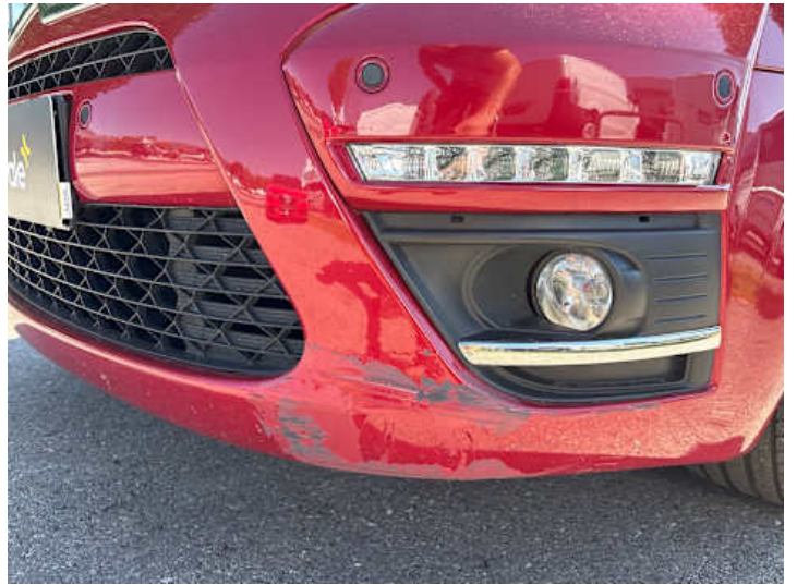
Stoßstange vorne (Kratzer, Lackschaden)
