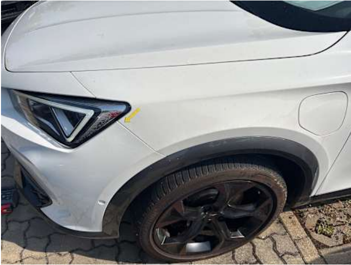
Stoßstange vorne (Spaltmaße ungenau)
