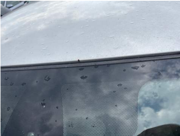
Dach (Steinschlag, Rost)
