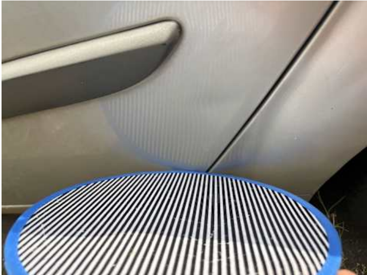
Türe hinten links (Delle)
