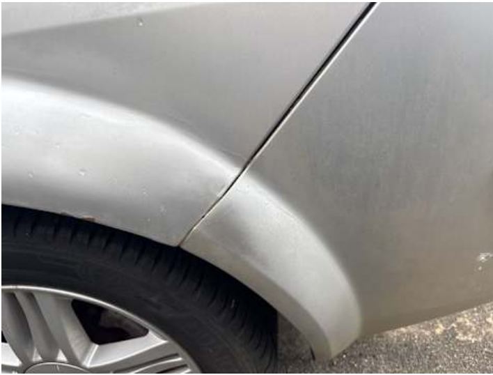
Stoßstange hinten (Unsachgemäß instand gesetzt, Lackschaden, Spaltmaße ungenau)
