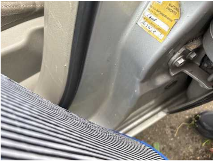
Fahrtür (Kratzer, Delle)
