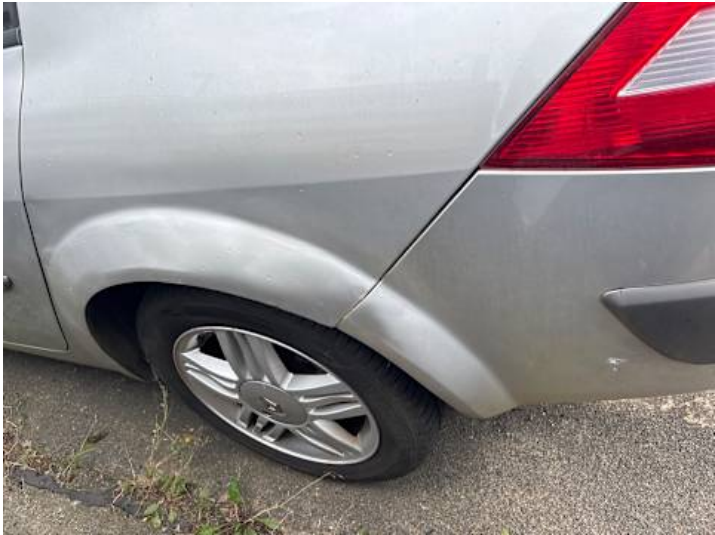
Stoßstange hinten (Unsachgemäß instand gesetzt, Lackschaden, Spaltmaße ungenau)
