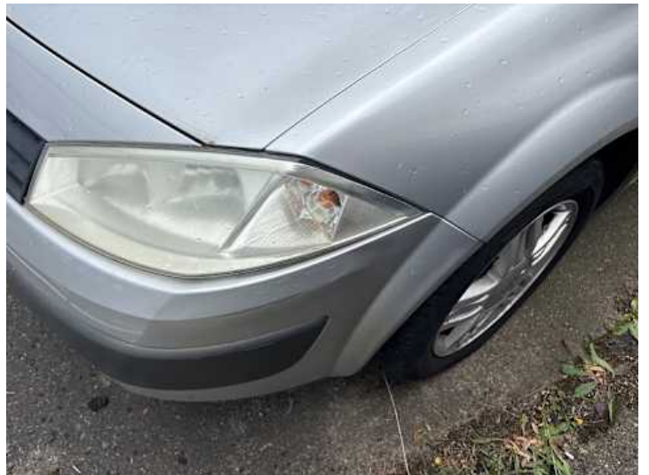
Stoßstange vorne (Spaltmaße ungenau)
