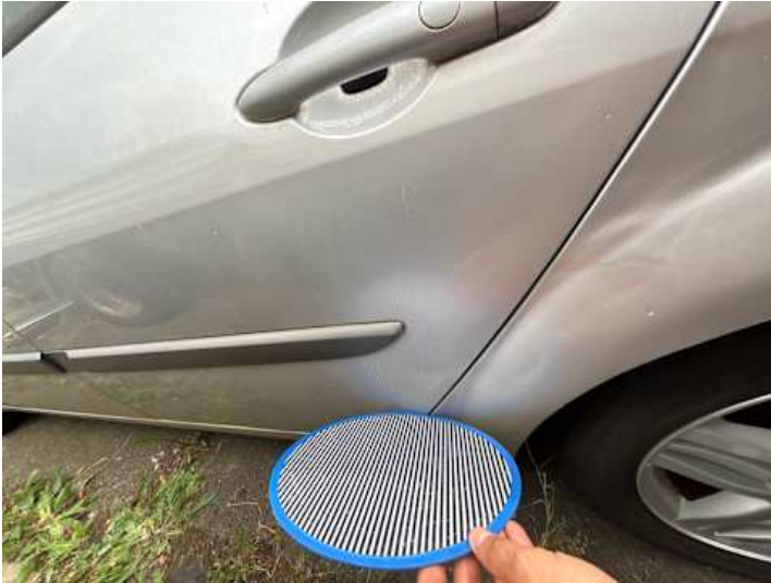
Türe hinten links (Delle)
