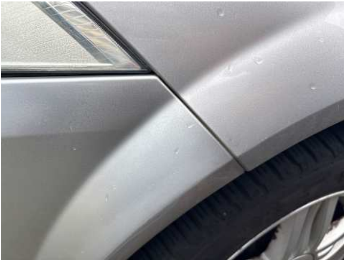
Stoßstange vorne (Spaltmaße ungenau)
