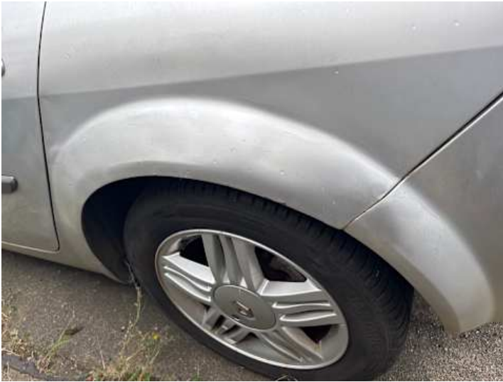
Seitenteil hinten links (Lackschaden, Unsachgemäß instand gesetzt)
