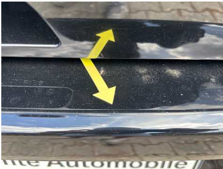
Stoßstange hinten (Unsachgemäß instand gesetzt)
