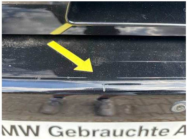
Stoßstange hinten (Unsachgemäß instand gesetzt)
